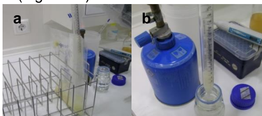
Figura 6 – a) Pipetagem de 100 mL de amostra através do filtro do BagFilter . b) Transferência de 100 mL de amostras para o frasco de Shott com volume máximo de 100 mL. (Fotografias do autor).
