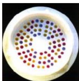
Figura 4 - Colónias características de E. coli (azuis) e coliformes (laranja a roxo) numa placa de CEc (Silva, 2002).
