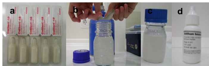
Figura 7 – a) Colilert®-18. b) Adição do meio de cultura Colilert-18® aos 100 mL de amostra. c) Mistura amostra/reagente em repouso. d) Reagente Antifoam Solution para o desaparecimento de espuma. (Fotografias do autor).
