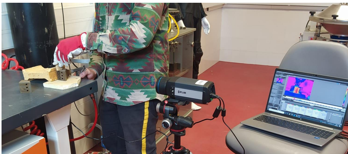
Figura 65 - Fotografia da realização dos testes aos provetes a baixa temperatura (200°C)
