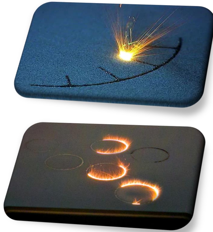
Figura 20 - Varrimento laser na camada durante o processo SLM.
