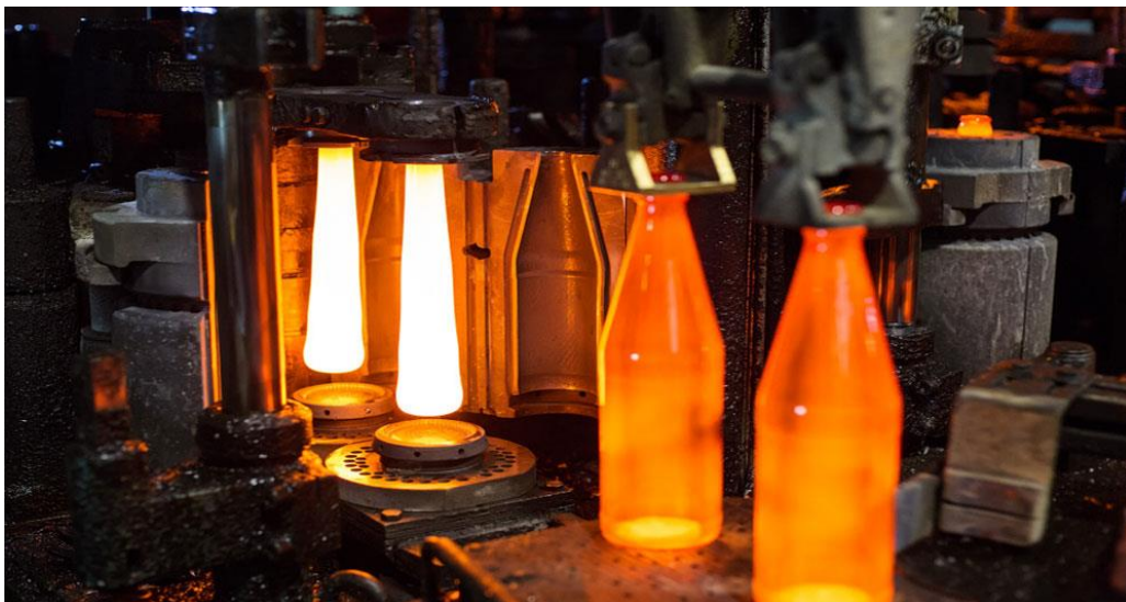
Figura 4 - Imagem do processo soprado-soprado. À esquerda: párison soprado já invertido aguardando o fecho do molde final. À direita: embalagem conformada pelo molde final.
