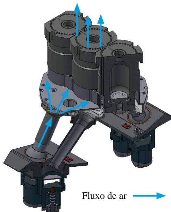
Figura 13 - Solução para ventilação contínua dos moldes pela Heye International GmbH [12].
