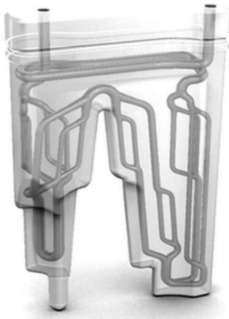
Figura 21 - Canais conformáveis vascularizados (biomimética). Do estudo de Berger et all [16].
