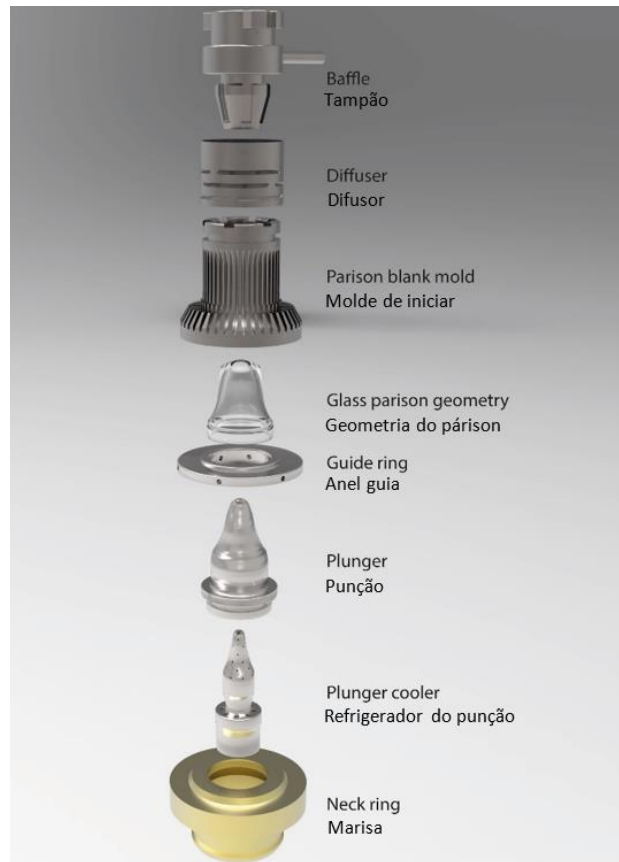
Figura 2 - Componentes do molde de iniciar de um frasco de compota.
