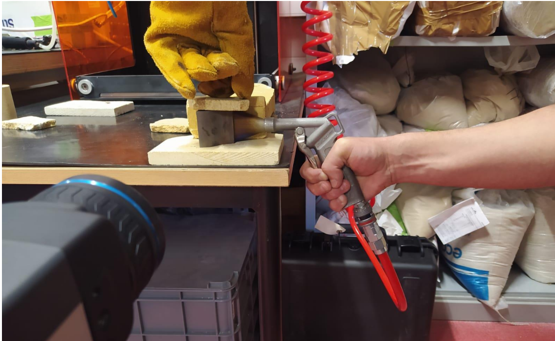
Figura 66 - Fotografia da realização dos testes aos provetes a alta temperatura (500°C e 650°C)
