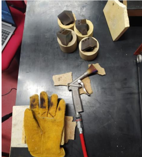
Figura 67 - Bancada de trabalho, material de enforna (refratários), luvas de proteção e pistola de ar com a ponteira desenvolvida instalada.
