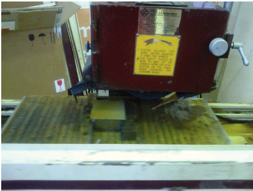
Figura 3.47 – Rectificadora para acabamento do amplificador
