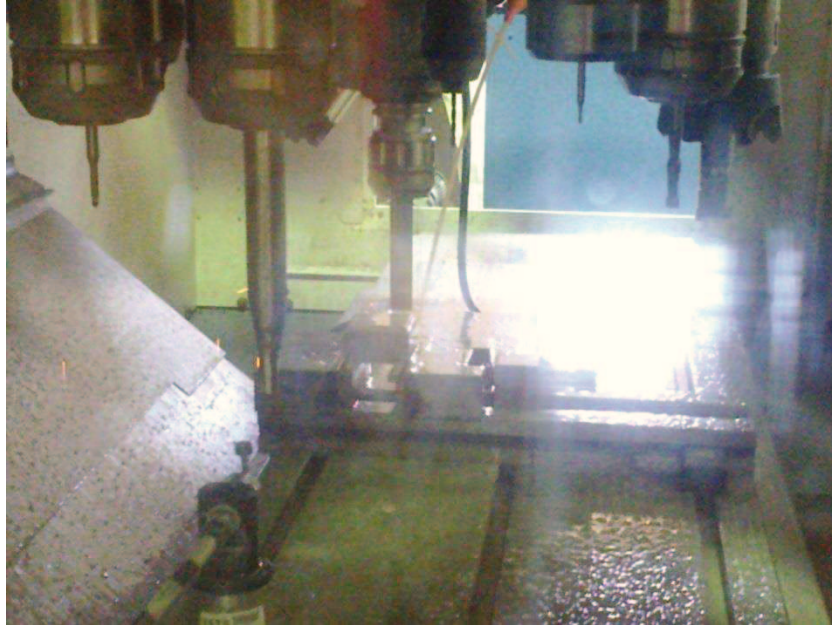
Figura 3.46 – Maquinação na CNC a maquirar a primeira geometria em aço
