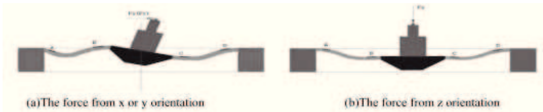
Figura 2.27 – Modelo de deformação do sensor quando aplicada uma força das três orientações
