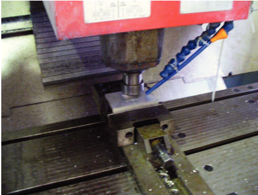
Figura 3.49 – Máquina CNC a maquinar uma das geometrias em alumínio
