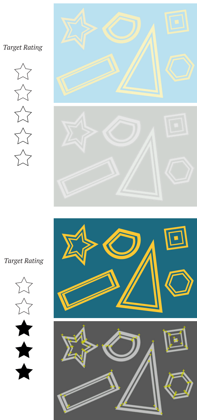
Fig. 15 Comparação de pontos de interesse entre imagens com pouco e bastante contraste no Vuforia Engine .
