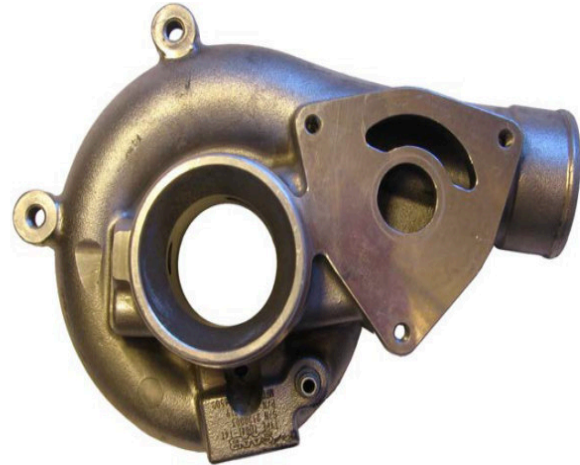
Figura 2.27: Exemplo de uma voluta do compressor, com o local de aplicação de uma válvula de prevenção de surge (Leufvén, 2013).
