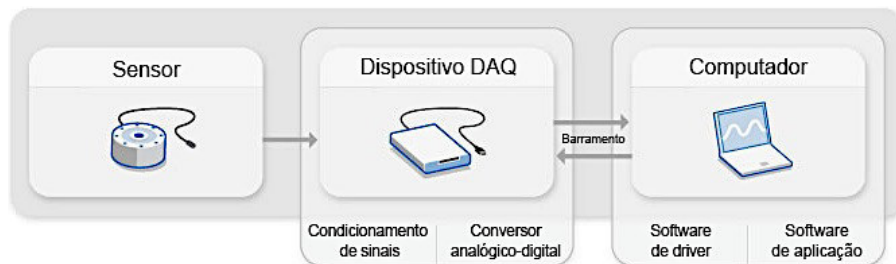
Figura 3.20: Composição de um sistema de aquisição de dados (National Instruments, 2013).
