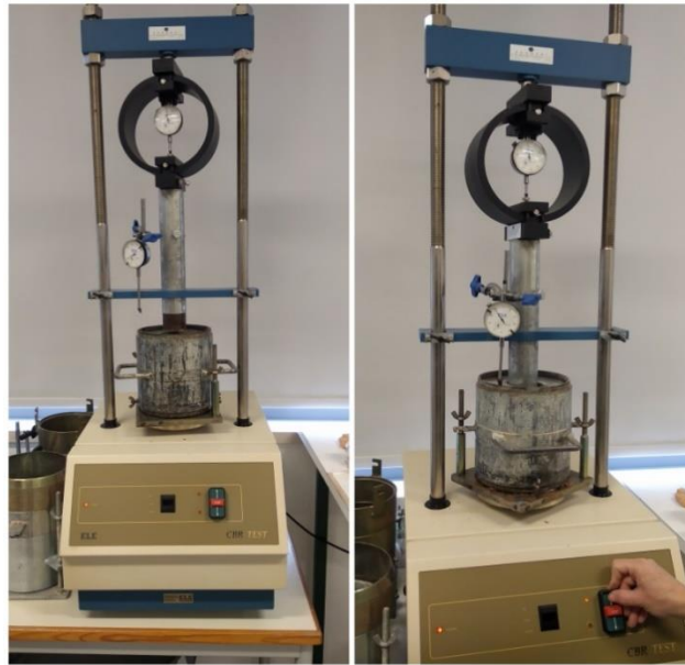
Figura 3.15 – Determinação do CBR
