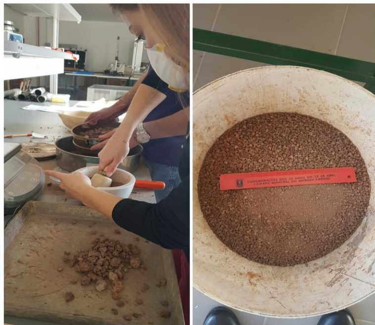
Figura 3.8 – Preparação das amostras para o ensaio de compactação Proctor
