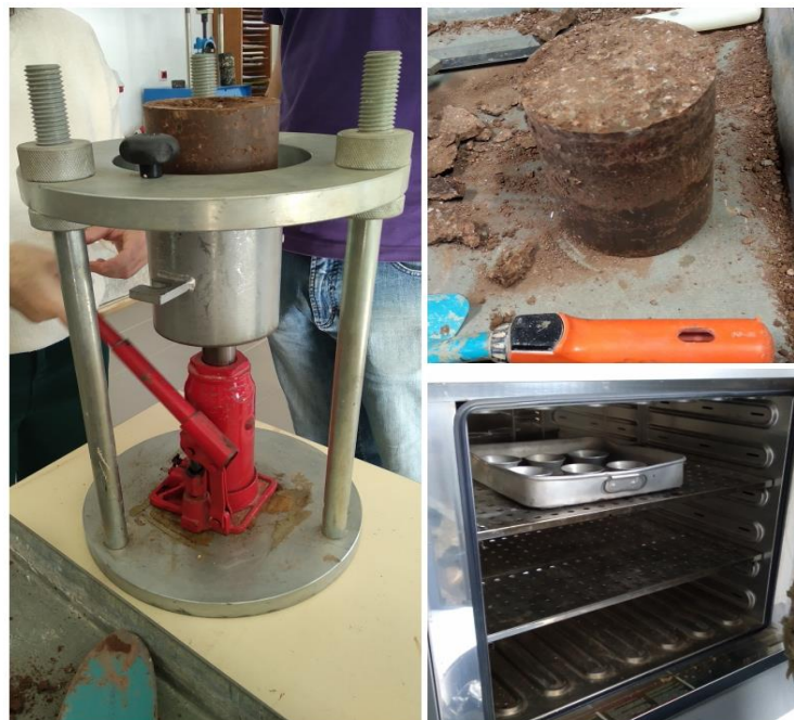
Figura 3.12 – Extração do provete para determinação do teor de umidade
