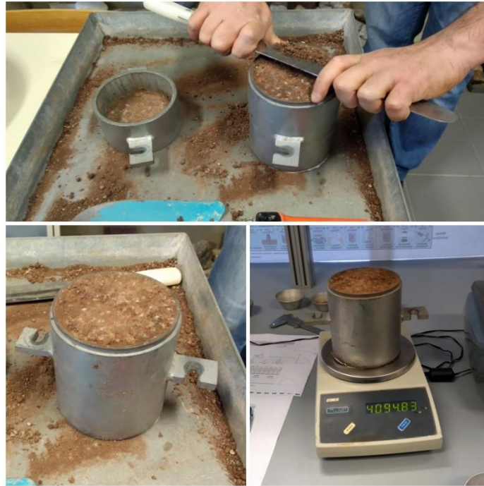
Figura 3.11 – Provete antes da extração do molde
