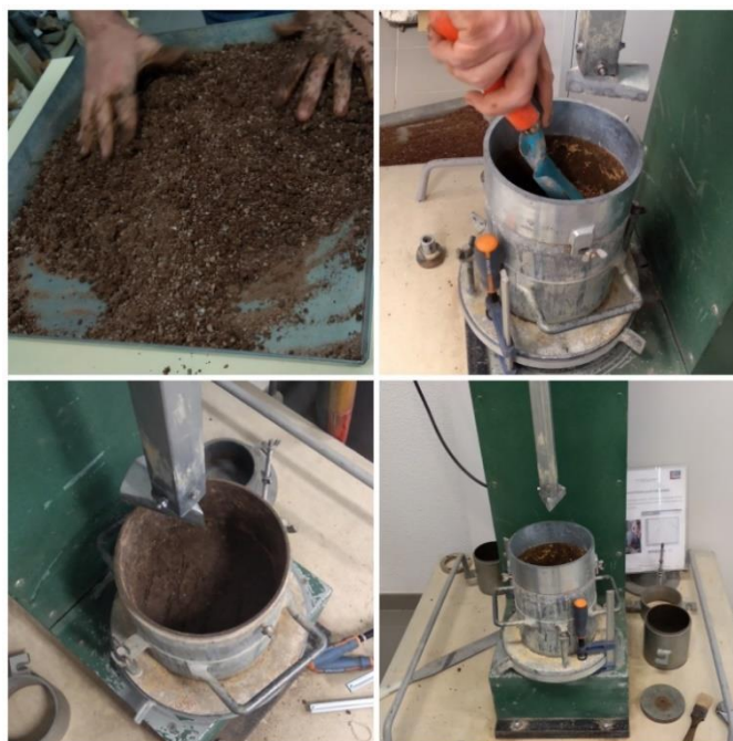
Figura 3.13 – Preparação e moldagem do provete
