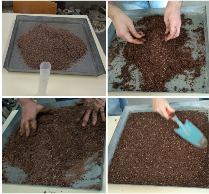
Figura 3.9 – Mistura do solo com água para ensaio de Compactação Proctor
