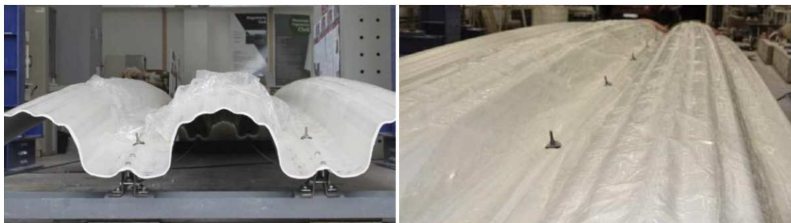
Figura 56 - Condições de apoio das telhas de aço autoportantes: (a) aparelhos de apoio e (b) Costura longitudinal entre telhas [46].
