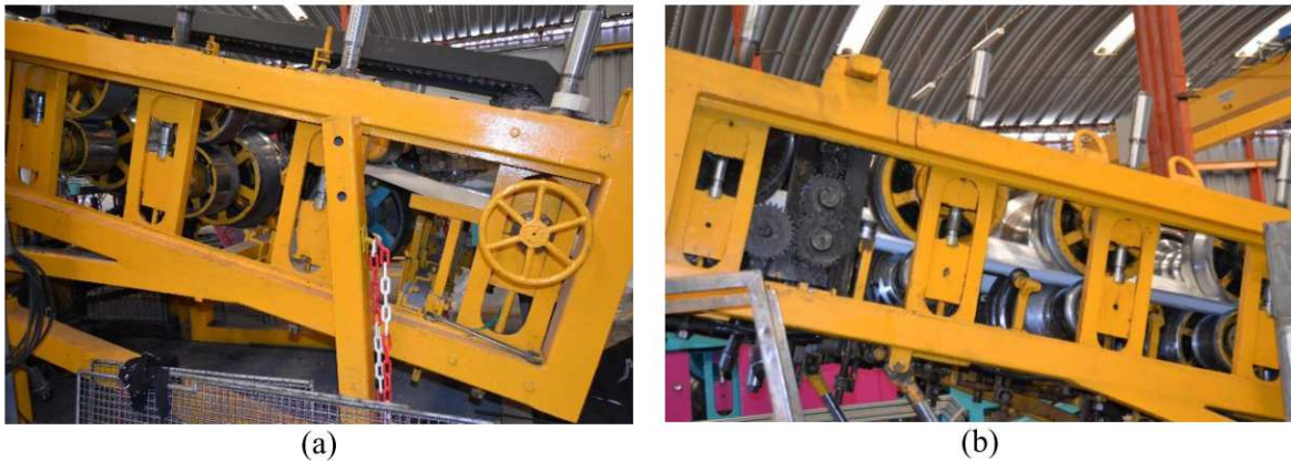
Figura 16 – Perfilagem (a) entrada da chapa na perfiladora, (b) rolos da perfiladora e hidráulicos inferiores.
