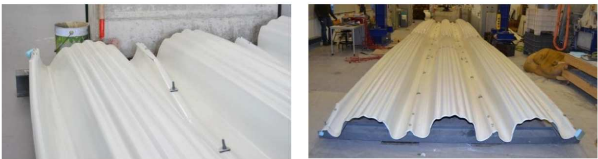
Figura 76 - Ensaios experimentais: Deformação dos bordos [46].
