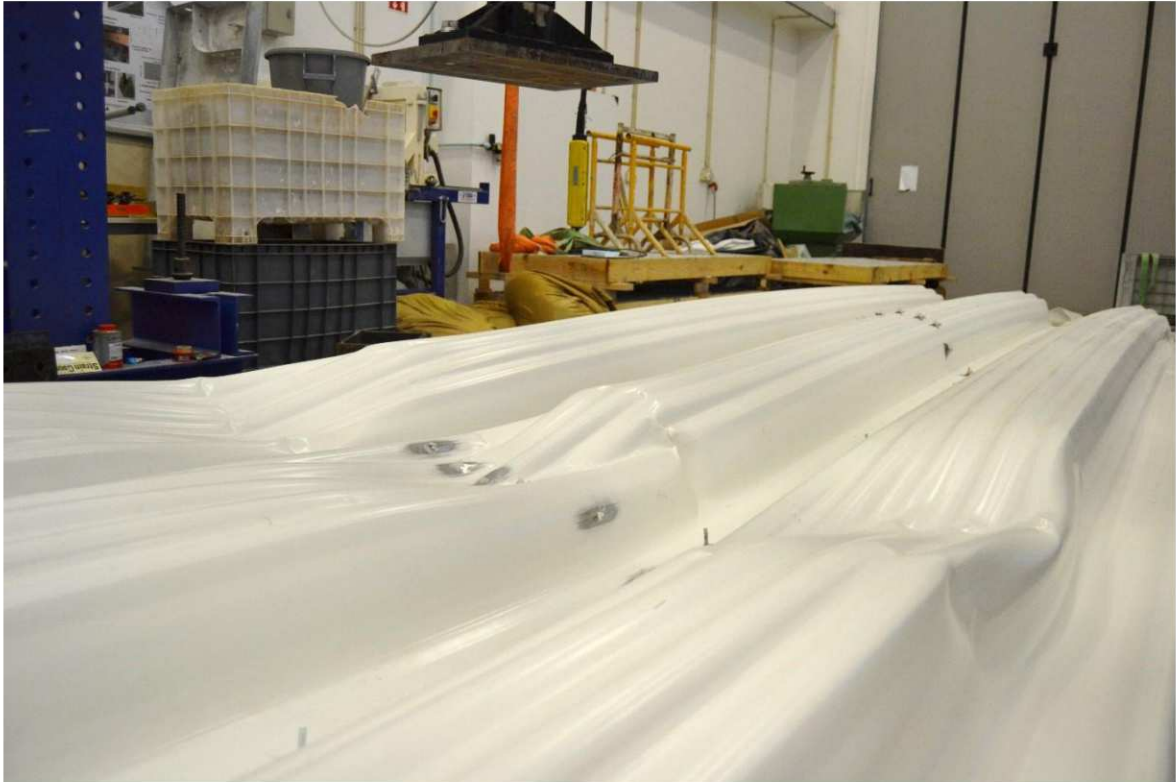
Figura 75 - Mecanismo de rotura nos ensaios experimentais [46].
