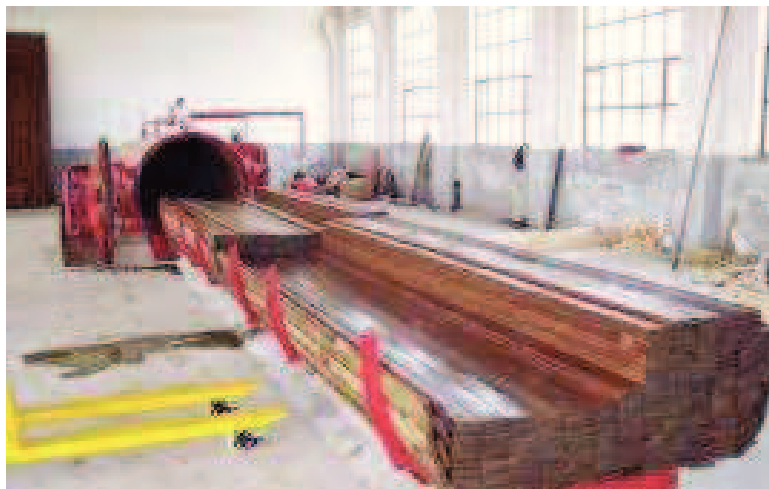
Figura 51 - Placas de cortiça depois do processo de Autoclave
