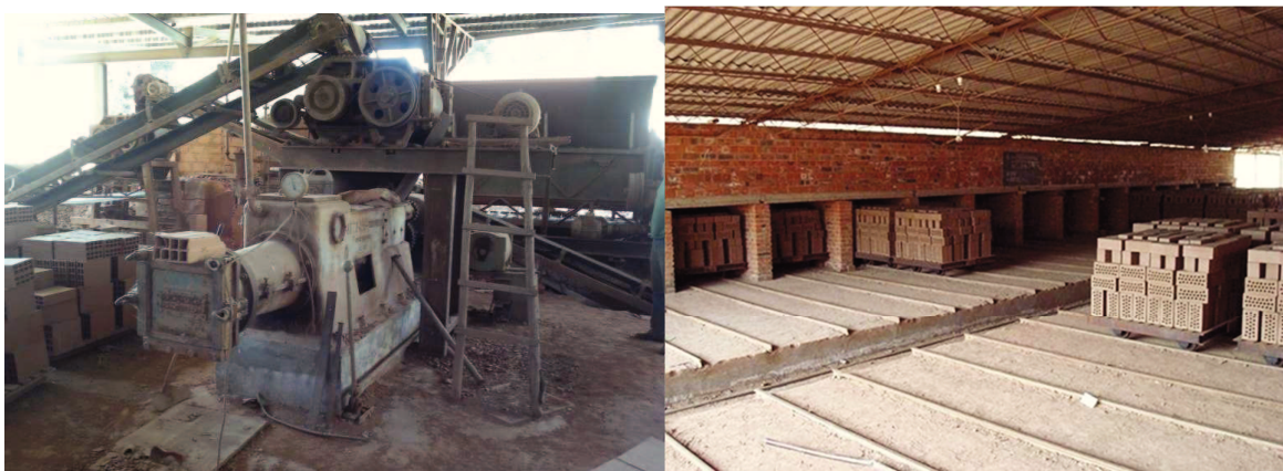
Figura 41 - Exemplo de um misturador de argila e forno de cozimento de tijolo respectivamente
