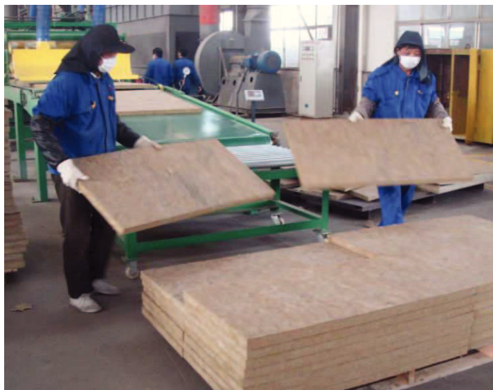
Figura 55 - Produção de placas de lã de rocha
