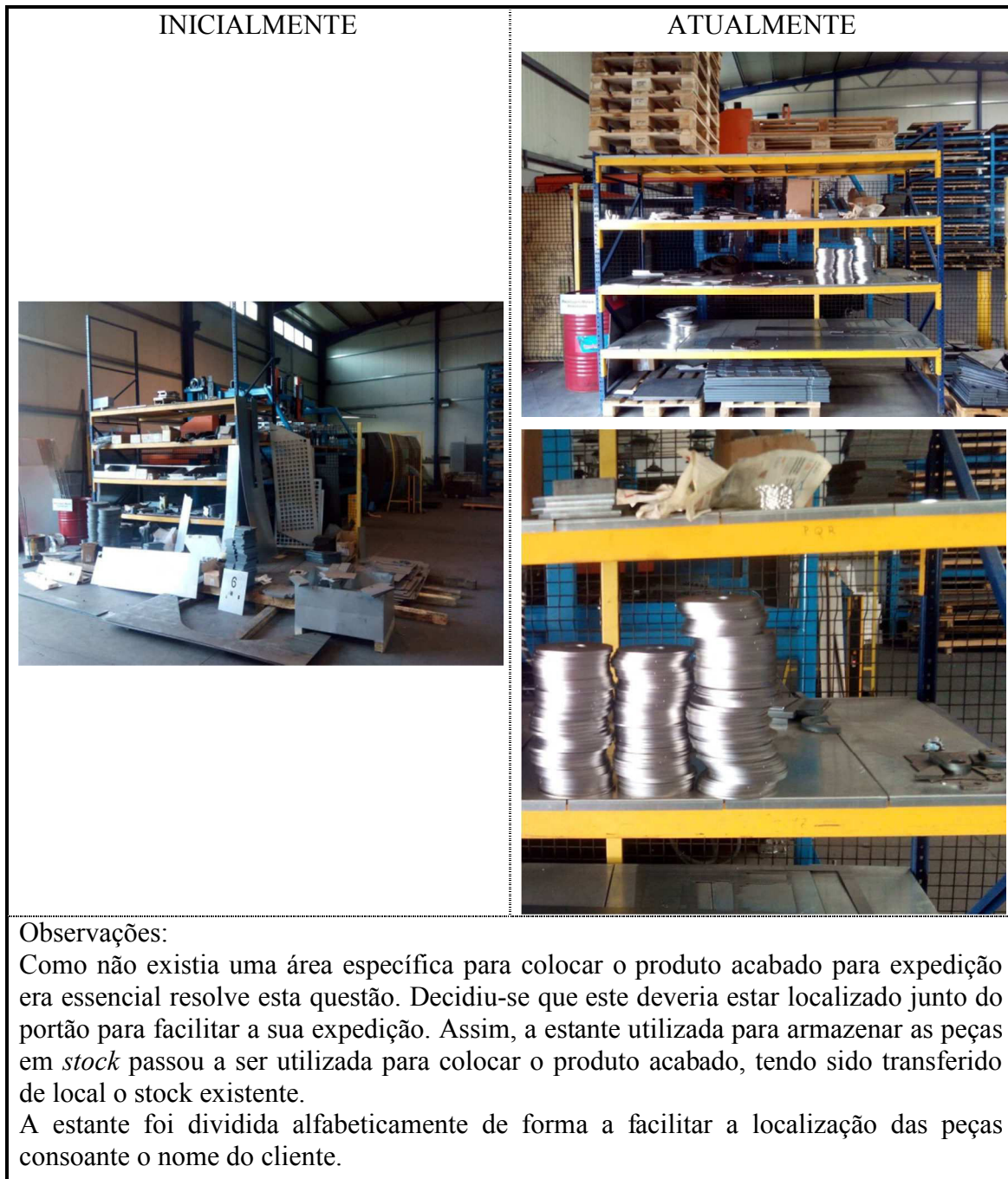
Figura 41 – Estante na zona de acesso ao portão na seção de corte.
