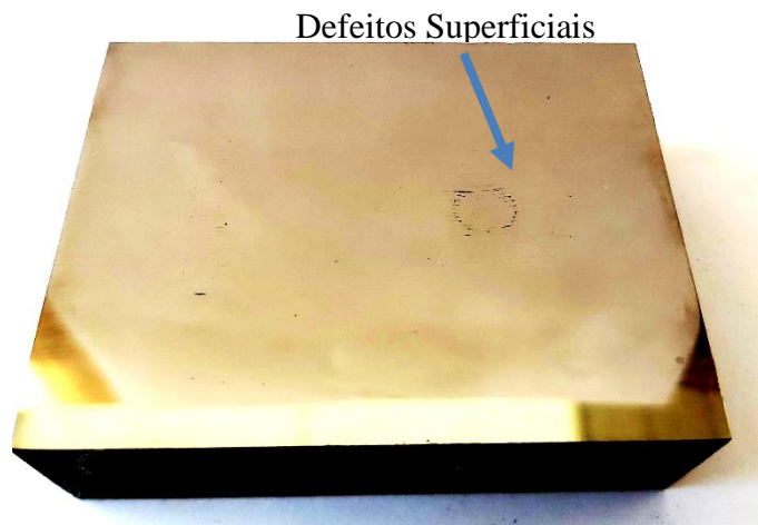
Figura 4.3 - Aspecto visual Provete n.º 16, defeitos superficiais
