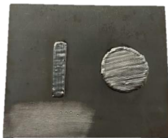
Figura 3.5 - Provete n.º38 após Soldadura LASER
