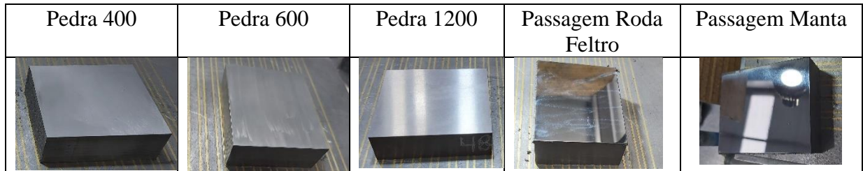
Figura 3.10 - Aspeto do provete durante Polimento
