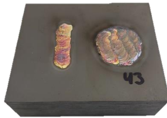
Figura 3.3 - Provete n.º43 após Soldadura TIG
