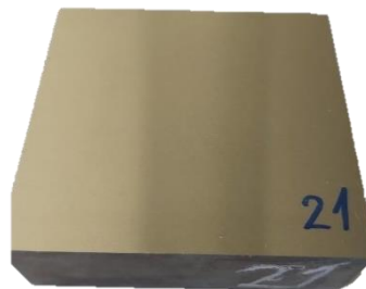
Figura 3.8 - Provet n°21 após retificação
