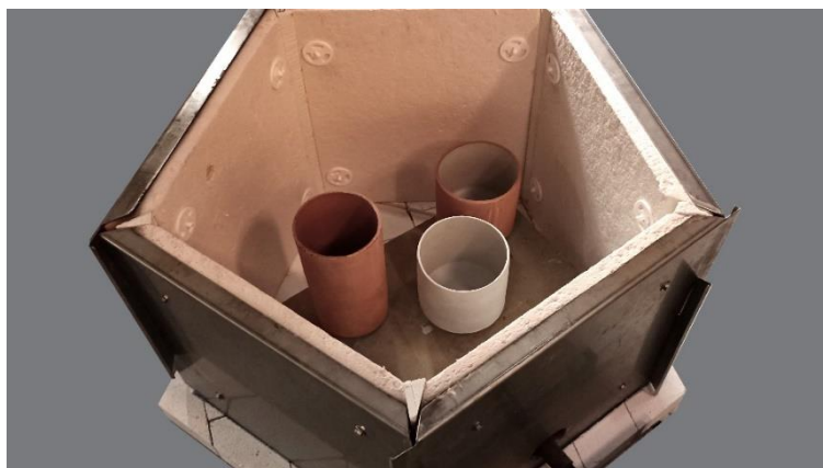
Figura 56 Enforna com o forno montado em pentágono.
