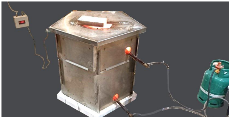
Figura 65 Forno com os dois queimadores em actividade.
