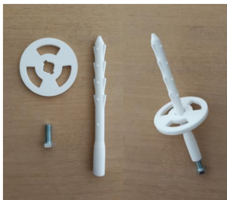
Figura 42 Anilha e perno cerâmico, desmontado e montado.
