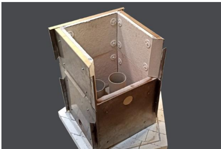
Figura 57 Pormenor do forno com os dois anéis acoplados sem uma parede.
