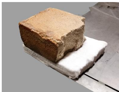
Figura 30 Colagem de tijolo em cima da manta refratária.
