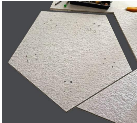
Figura 36 Corte da placa rígida em fibra.
