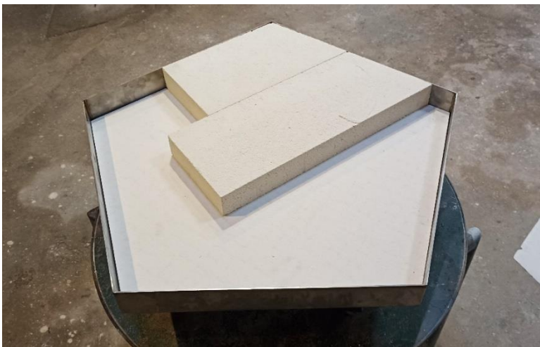
Figura 58 Nova base com uma dobra metálica vertical superior.
