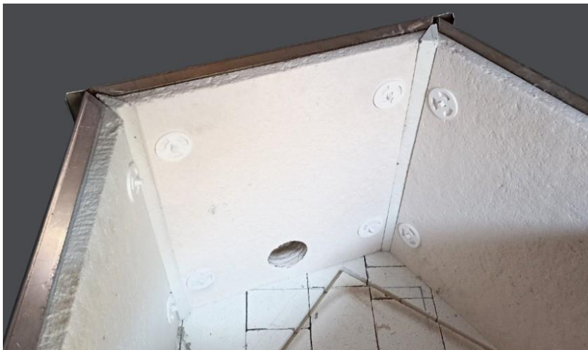
Figura 55 Cunhas acopladas aos ângulos entre as paredes.
