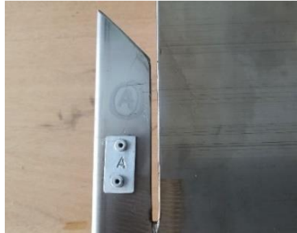
Figura 44 Chapa de identificação para encaixe das paredes.
