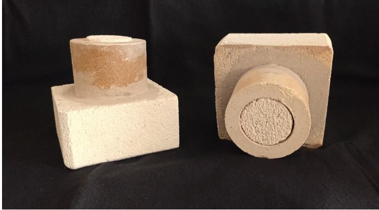
Figura 32 Tampas refratárias para fecho das aberturas dos queimadores.
