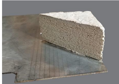
Figura 27 Colagem de tijolo refractário na chapa de aço.
