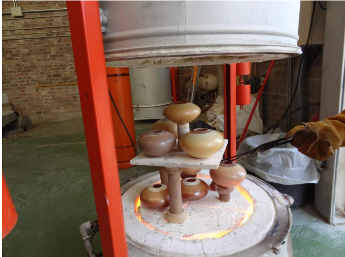
Figura 16 Forno para Raku com a enforna a ser feita inferiormente.
