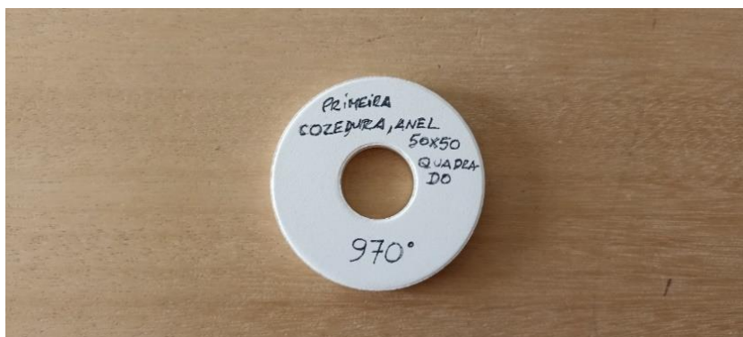
Figura 53 Descrição da leitura do anel de Buller retirado do forno.
