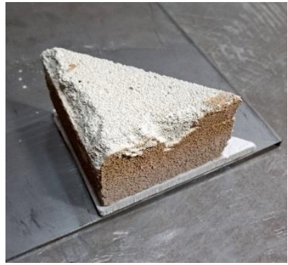
Figura 29 Colagem da placa rígida sobreposta com tijolo colados à chapa de aço.
