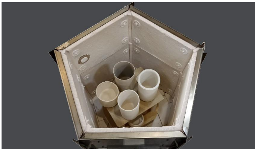
Figura 64 Pormenor da enfora com forno acoplado em pentágono.
