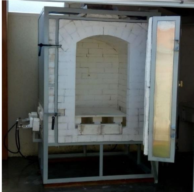
Figura 13 Forno de combustão a gás.
