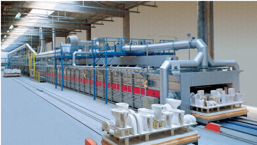
Figura 15 Forno industrial de vagão, combustão a gás.
