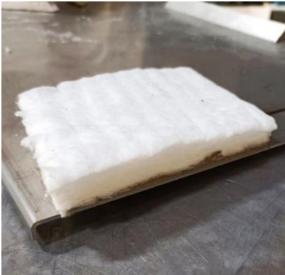
Figura 28 Colagem da manta em fibra na chapa de aço.
