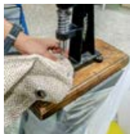
Figura 273. Colocando los botones de presión. Fuente: Fotografía de Autor (2022).
