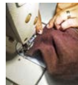
Figura 330. Fijando el forro a la base. Fuente: Fotografía de Autor (2022).
