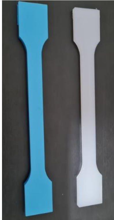
Figura 31 - Provetes produzidos a partir de peças de produção
