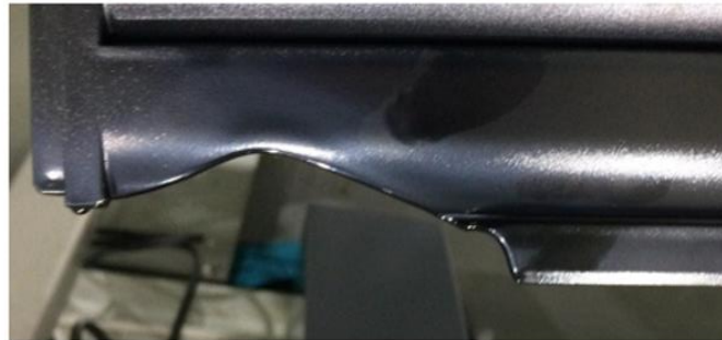
Figura 5 - Defeito típico de peça incompleta
