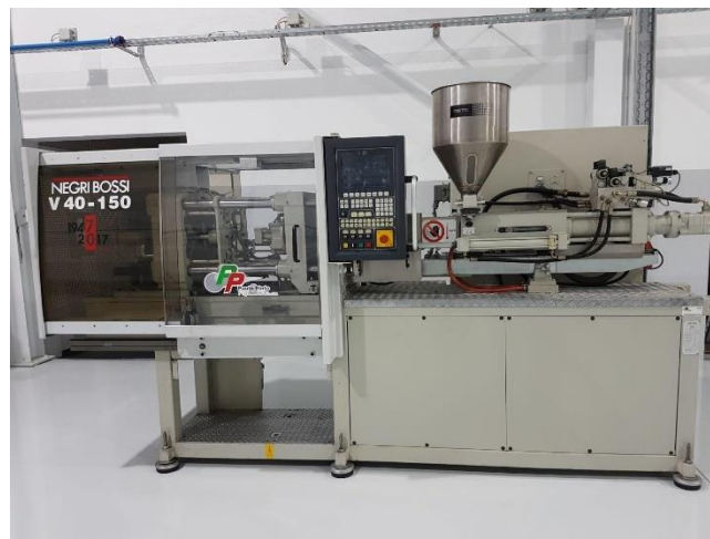
Figura 27 - Máquina de injeção (Negri Bossi – 40 t)
