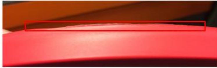
Figura 4 – Defeito típico de rebarba
