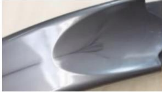
Figura 7 - Defeito típico de linha de fluxo
