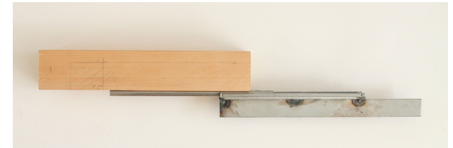
Figs. 52 e 53 Sistema com corredeira e chapa soldada.
