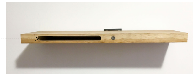
Fig. 36 Teste 1 - Parte do interior da placa foi retirado.
