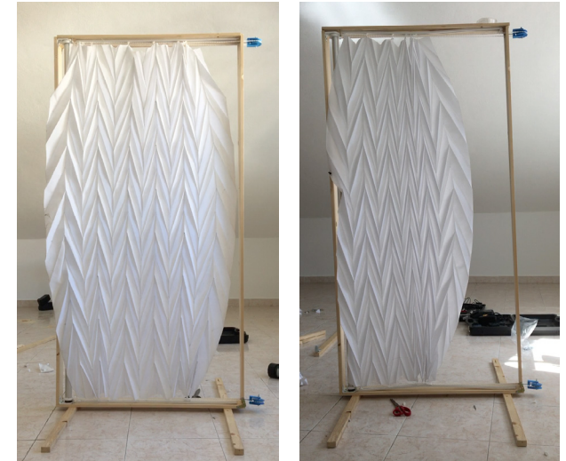
Figs. 98 e 99 Instabilidade na abertura e fecho do origami .
