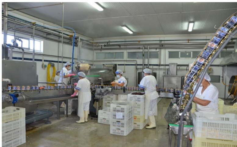
Figura 3.1 – Preparação das latas (enchimento). Fonte própria.
