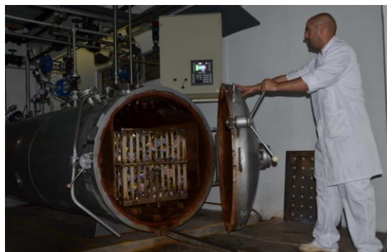
Figura 3.2 – Entrada das latas no esterilizador. Fonte própria.
