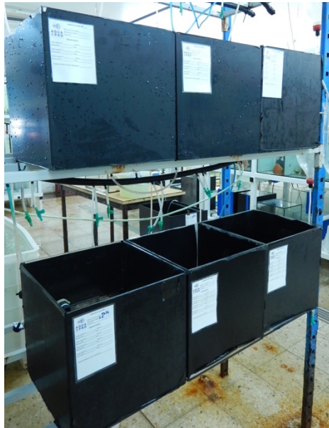
Figura 4.3 – Aquários de cultivo larvar utilizados no ensaio.
