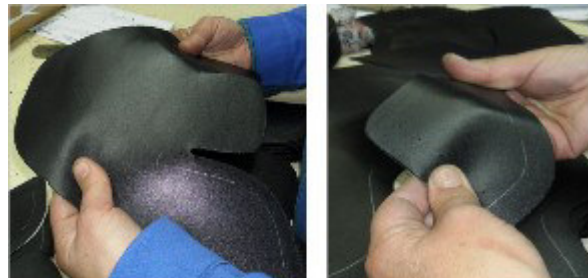
Figura 13: Ilustração da inspeção de peças de couro que constituem a parte superior do calçado no PI1.
