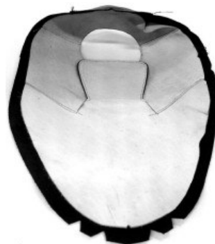
Figura 9: Forro que reveste internamente a parte superior que envolve o pé
