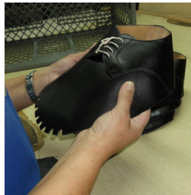
Figura 15: Ilustração da inspeção da parte superior do calçado no PI2.
