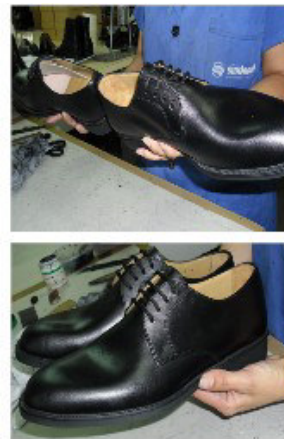
Figura 16: Ilustração da inspeção do produto acabado no posto de inspeção 3.
