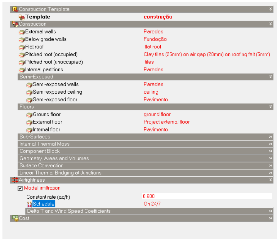
Figura 29 Entrada de dados Designbuilder - elementos construtivos
