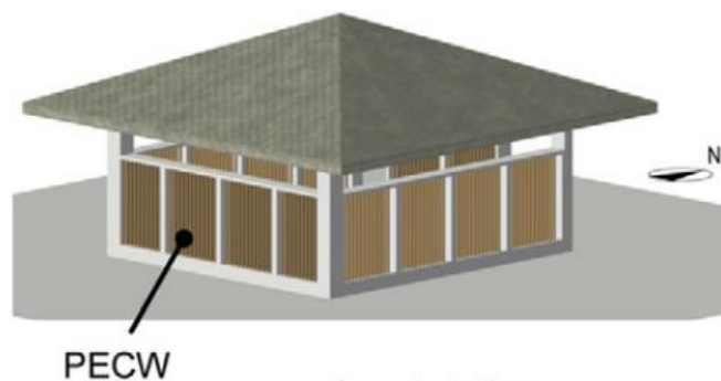
Figura 15 Paredes de tubos cerâmicos para arrefecimento evaporativo (He & Hogano, 2009)
