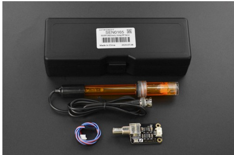
Figura 13: Sensor ORP utilizado no sistema (SEN08043).
