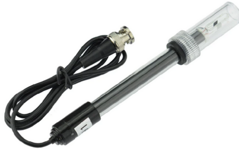
Figura 12: Sensor condutividade elétrica utilizado no sistema (SEN08024).
