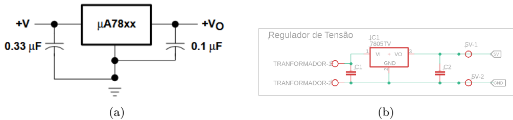
Figura 26: Regulador de tensão : (a) Exemplo do circuito de regulador de tensão. (b) Circuito implementado.
