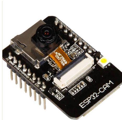
Figura 18: Módulo ESP32-CAM, com uma câmara.
