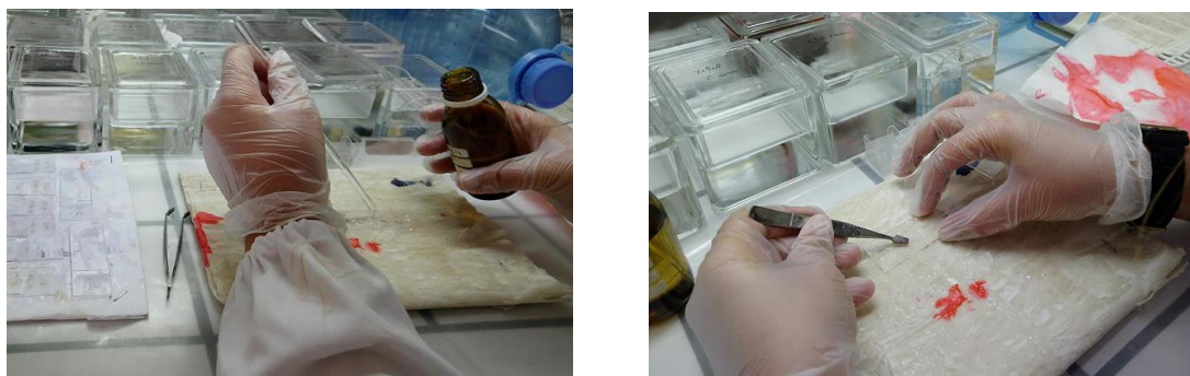
Figura 17 – Preparação definitiva dos tecidos: adição do meio de montagem sobre a lâmina (à esquerda) e colocação da lamela por cima dos tecidos (à direita).
