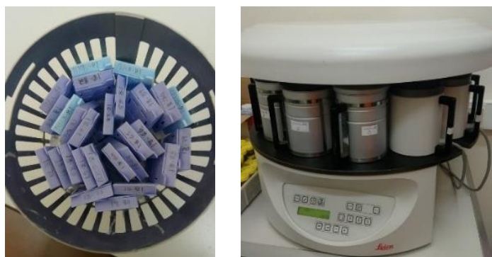
Figura 11 – Cesta com as cassetes histológicas (à esquerda); processador de tecidos (Processador Leica TP 1020, à direita).
