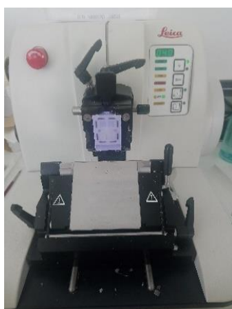
Figura 14 – Micrótomio utilizado para realizar os cortes com uma espessura de 4-5 \mu\text{m} .
