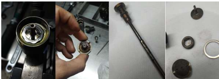
Figura 17 Injetores diesel contaminados: oxidação, desgaste e danos causados por combustível de má qualidade
