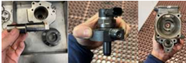
Figura 19 Peças de bomba Common Rail em análise e desgaste
