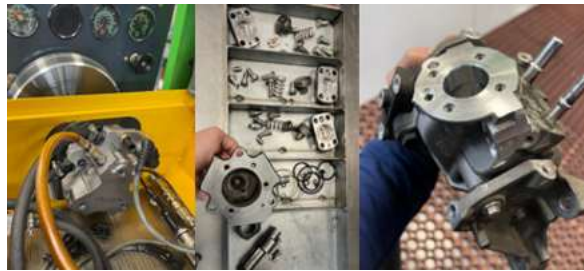
Figura 15 Inspeção de componentes internos de bomba de injeção
