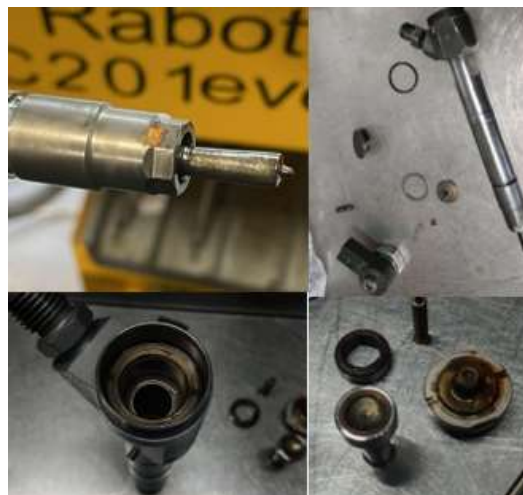
Figura 14 Desgaste e componentes internos de injetores diesel Common Rail em processo de inspeção e manutenção
