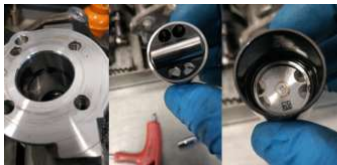
Figura 16 Componentes internos de bomba de alta pressão diesel em processo de desmontagem e inspeção técnica
