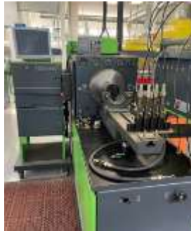
Figura 20 Banco de testes Bosch para sistemas de injeção diesel
