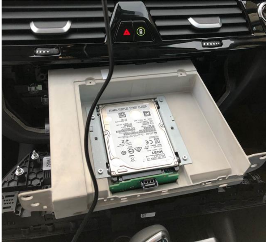
Figura 54 - Sistema IVI sem a unidade CD/DVD [4]
