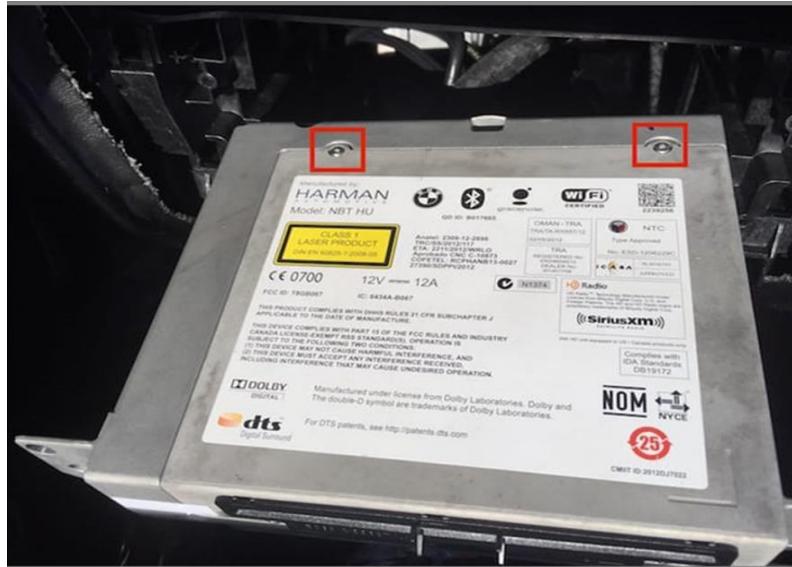
Figura 52 - Remoção dos parafusos da parte de cima [4]
