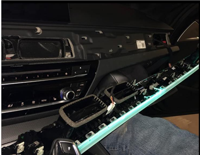
Figura 48 - Remoção da guarnição que corre ao longo do tablier [4]
