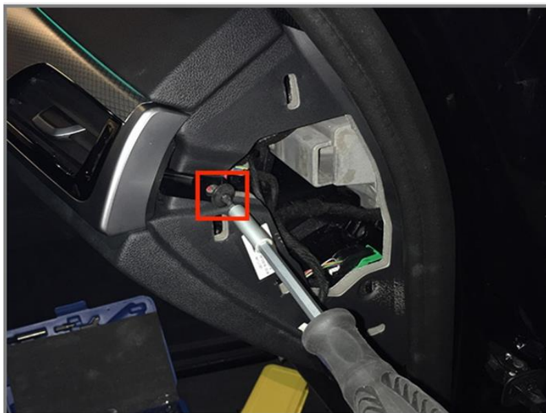
Figura 47 - Remoção o parafuso na extremidade do tablier [4]
