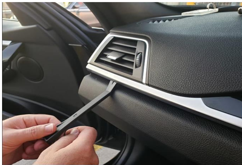
Figura 57 - Remoção da peça do Tablier parte1 [4]
