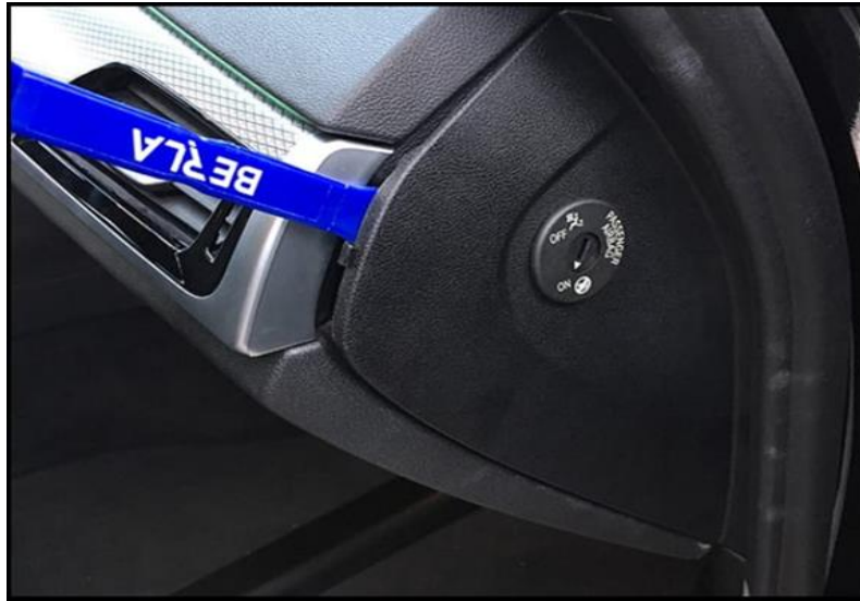
Figura 46 - Remoção da peça do lado direito do tablier [4]
