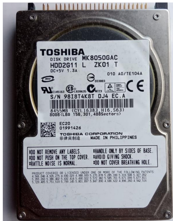
Figura 63 - Disco rígido do sistema IVI CIC ano 2010
