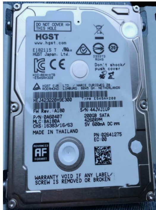
Figura 56 - Disco rígido do sistema IVI NBT
