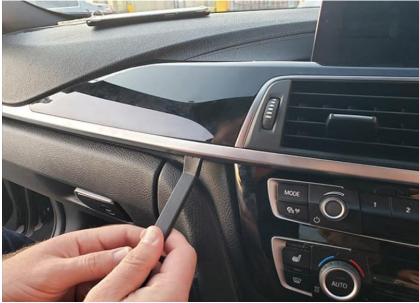
Figura 58 - Remoção da peça do tablier parte 2 [4]
