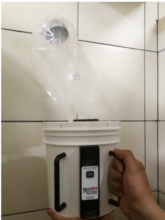
Aforo digital en las duchas de los colaboradores
