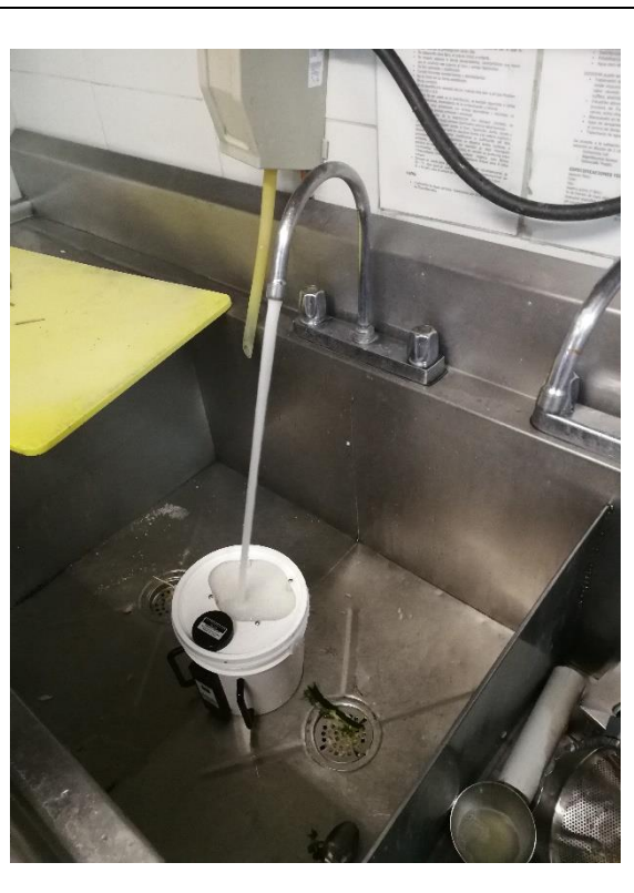
Aforo digital en llaves lavaplatos de la cocina (zona de pastelería)
