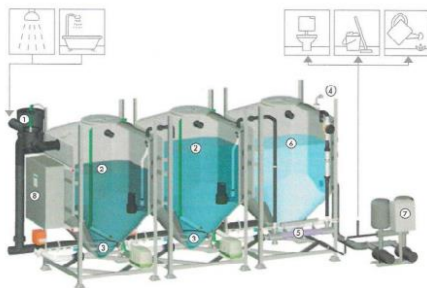
Figura 19: Representación esquemática de una instalación predial de un SPRRAG.
