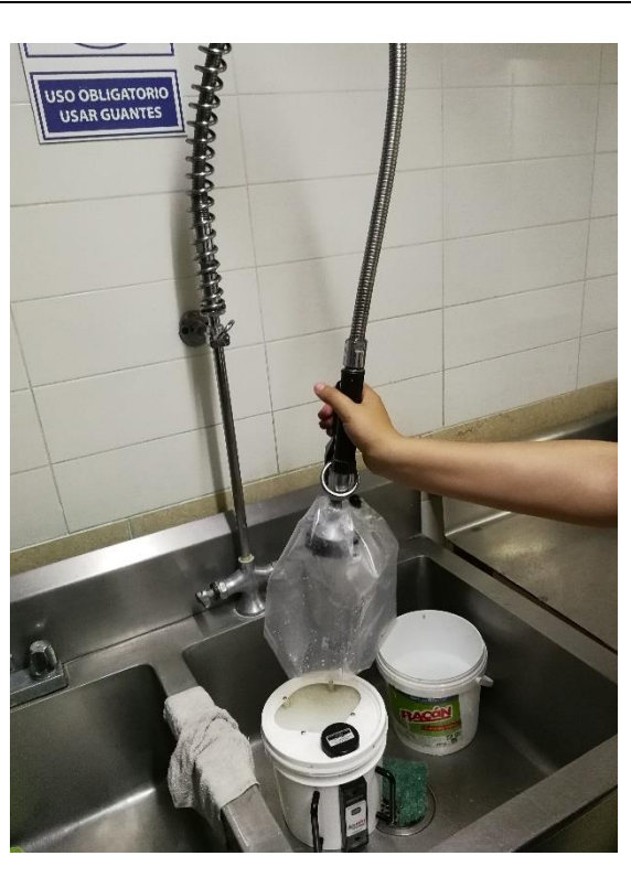
Aforo digital en llaves lavaplatos de la cocina
