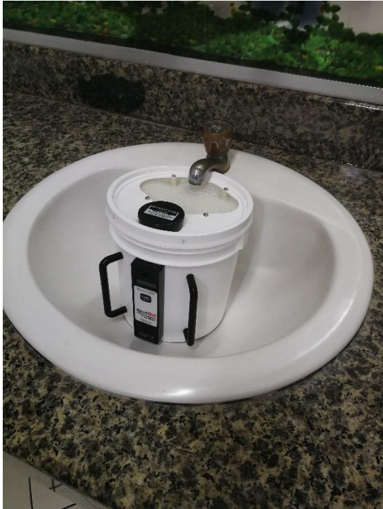
Aforo digital en el baño de colaboradores
