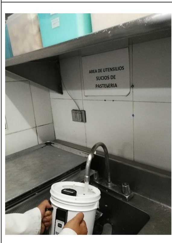
Aforo digital en llaves lavaplatos de la cocina (zona de pastelería)
