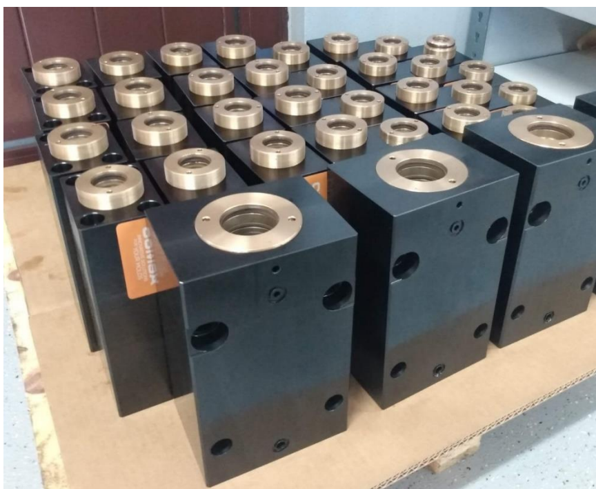
Figura 13: Cilindros hidráulicos após sofrerem o tratamento de Oxidação a Negro.
