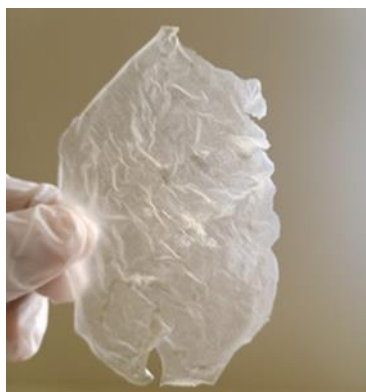
Figura 2.10. Película fina de carragenanas extraída da biomassa do Berçário 1.
