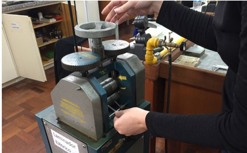
Figura 55: Lingote de metal passando pelo laminador. Fonte: Autora (2020).
