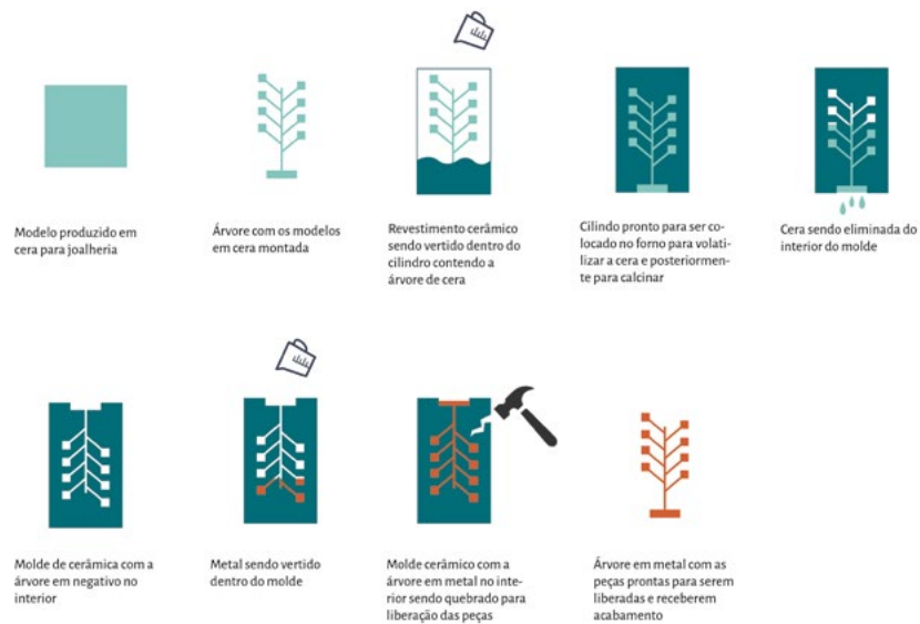
Figura 53: Esquema da produção por fundição de cera perdida Fonte: Autora (2020).
