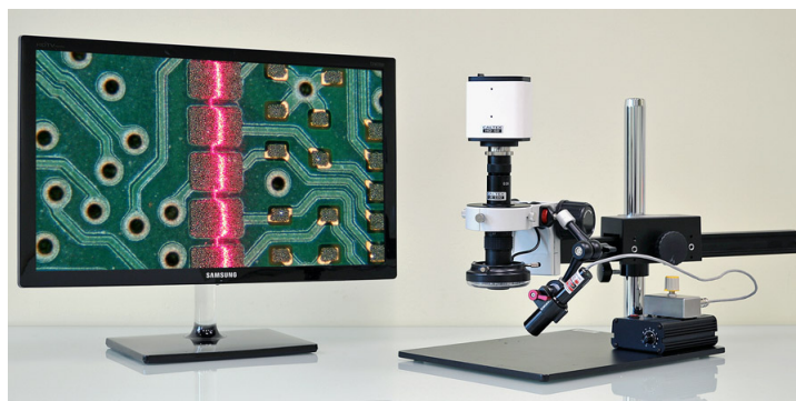
Figura 2.3: Exemplo de um sistema de inspeção com o método de triangulação laser [11].
