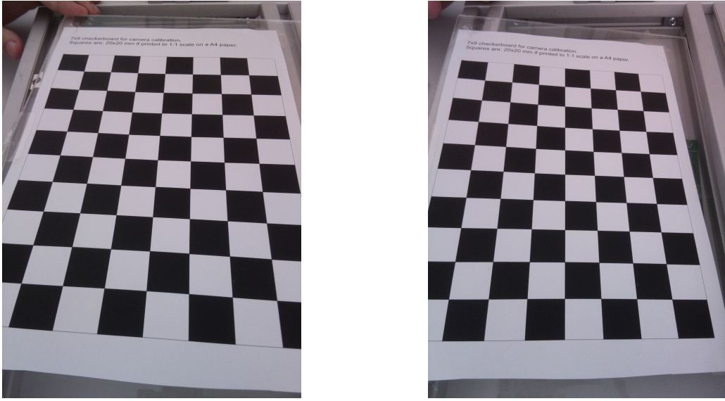
Figura 3.9: Exemplo das posições do xadrez de referência para a calibração. É necessário capturar várias imagens deste padrão em várias posições diferentes.
