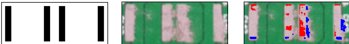
Figura 4.5: Pasta de solda espalhada assinalada a azul quando é fora do pad e a vermelho quando existe falta de solda. Imagem do Gerber à esquerda, imagem do pad ao centro e deteção da falta e excesso de solda à direita.
