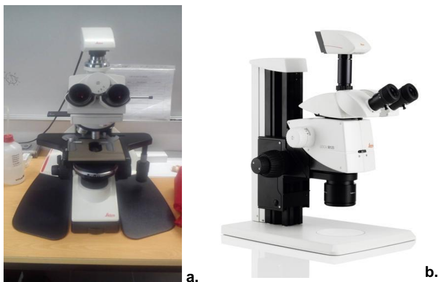
Figura 4: a. Microscópio Leica DM 2000 LED com câmara Leica MC 170 HD incluída (Autoria: Mónica Gomes, 2015) e b. Microscópio estereoscópico de dissecação DM 125 câmara Leica MC 170 HD incluída. (Autoria: http://www.leica-microsystems.com/products/stereo-microscopes-microscopes/research-manual/details/product/leica-dm125/ ).
