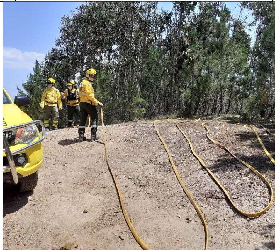
Manobra de Montagem de 5 Lances de Mangureira a partir do Veículo. Sapador nº1 aguarda linha em carga.
