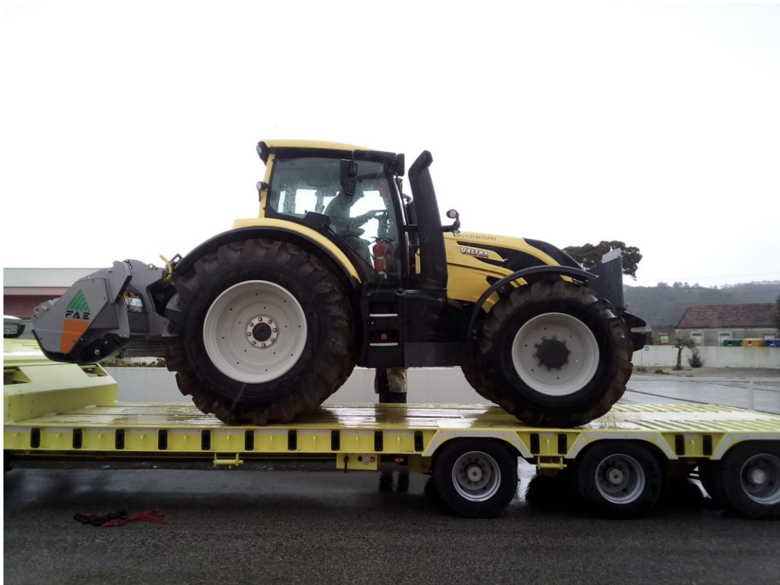
Figura 13 Trator Florestal com Alfaia - Destroçador de Martelos Fixos
