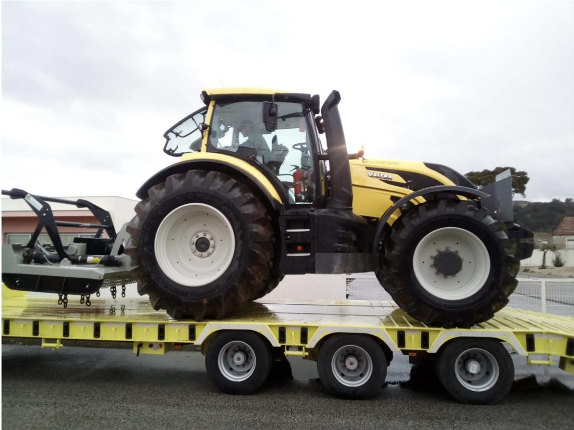
Figura 14 - Trator Florestal com Alfaia - Destroçador de Correntes
