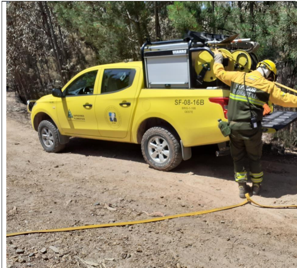
Manobra de Montagem de Linha de Mangueira a partir do Veículo. SF Motorista a engatar lance á moto-bomba.
