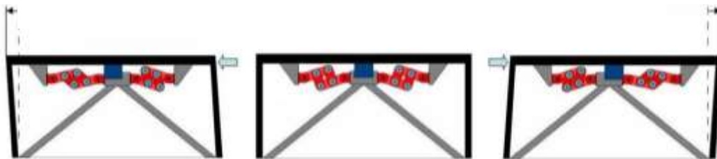
Figura 26. Mecanismo de un amortiguador de fricción.
