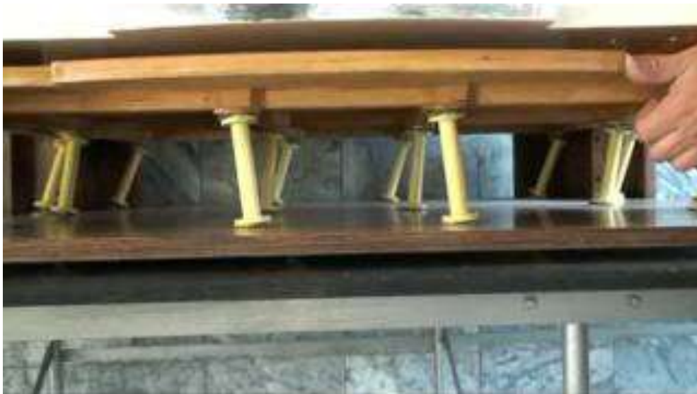
Figura 22. Modelo a escala de un sistema de aislamiento cinético.
