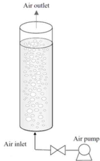
Figura 4 – Representação esquemática do reator coluna de bolhas de regime homogêneo (Adaptado de Krichnavaruk et al. , 2005).
