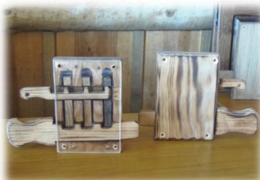
Figura 2.3 - Fechadura e Chave de Madeira
