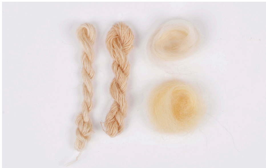
Fig. 132: Fios e lã penteada de Churra Badana, da esquerda para a direita: fio penteado, fibras longas; fio penteado, fibras médias.
