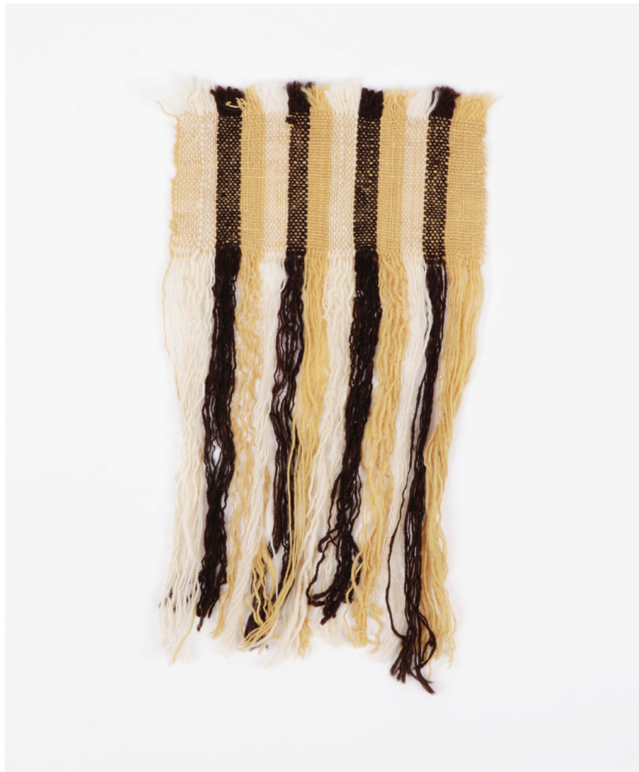
Fig. 254: Amostra VI - fim da teia, deixando os fios que a compõem visíveis; tafetá, estrutura neutra; trama: Churra do Minho tingida com figueira; 43cm x 24cm. Fonte: fotografia da autora (2025).
