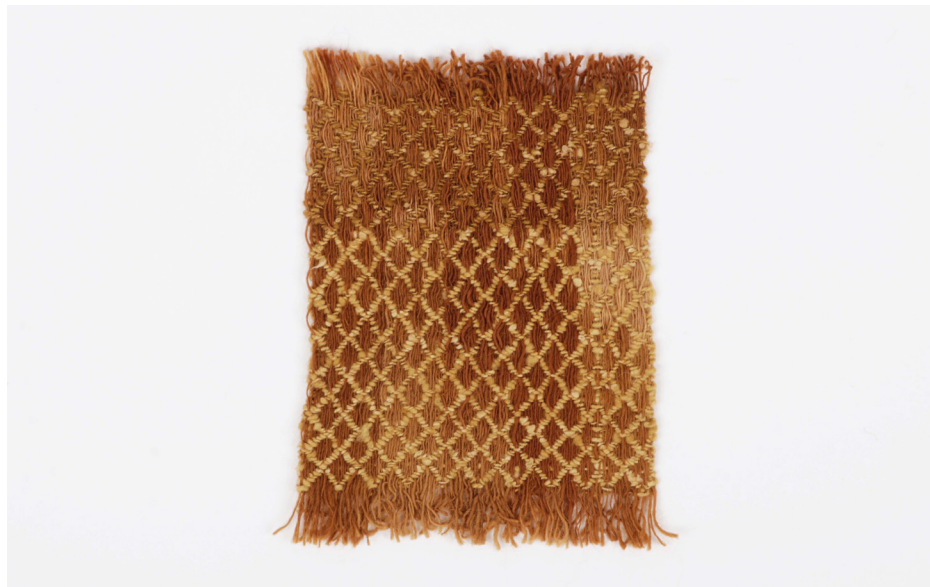
Fig. 265: Amostra I - frente; sarja 6x2; trama: Merino da Beira Baixa com anafaia tingida com oliveira e com oliveira e ferro; 26cm x 19cm. Fonte: fotografia da autora (2025).
