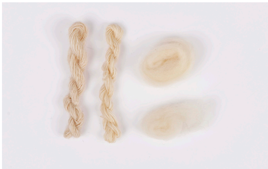
Fig. 123: Fios e lâs penteadas de Churra do Minho branca, da esquerda para a direita: fio penteado, fibras longas; fio penteado, fibras médias.
