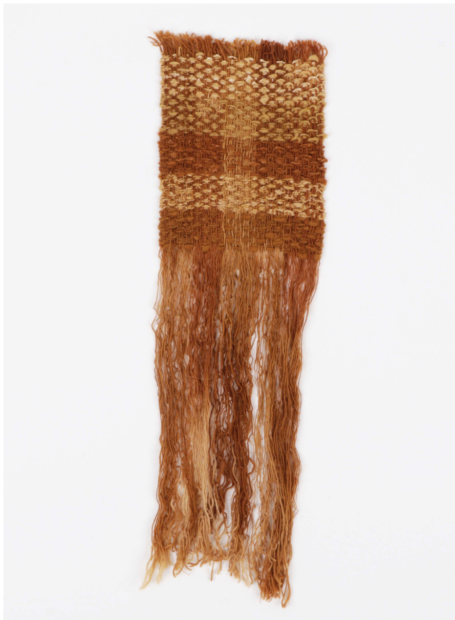
Fig. 275: Amostra VI - frente; fim da teia, deixando os fios que a compõem visíveis; sarja espinhada; trama: Merino da Beira Baixa com anafaiá tingida com amoreira, tamujo e eucalipto, e Merino da Beira Baixa tingida com oliveira e eucalipto; 58cm x 18cm. Fonte: fotografia da autora (2025).
