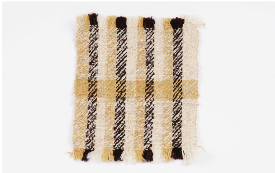
Fig. 248: Amostra II - frente; estrutura composta por sarja 1x3 e sarja 2x2; trama: Churra do Minho branca e tingida com figueira; 25cm x 22cm. Fonte: fotografia da autora (2025).
