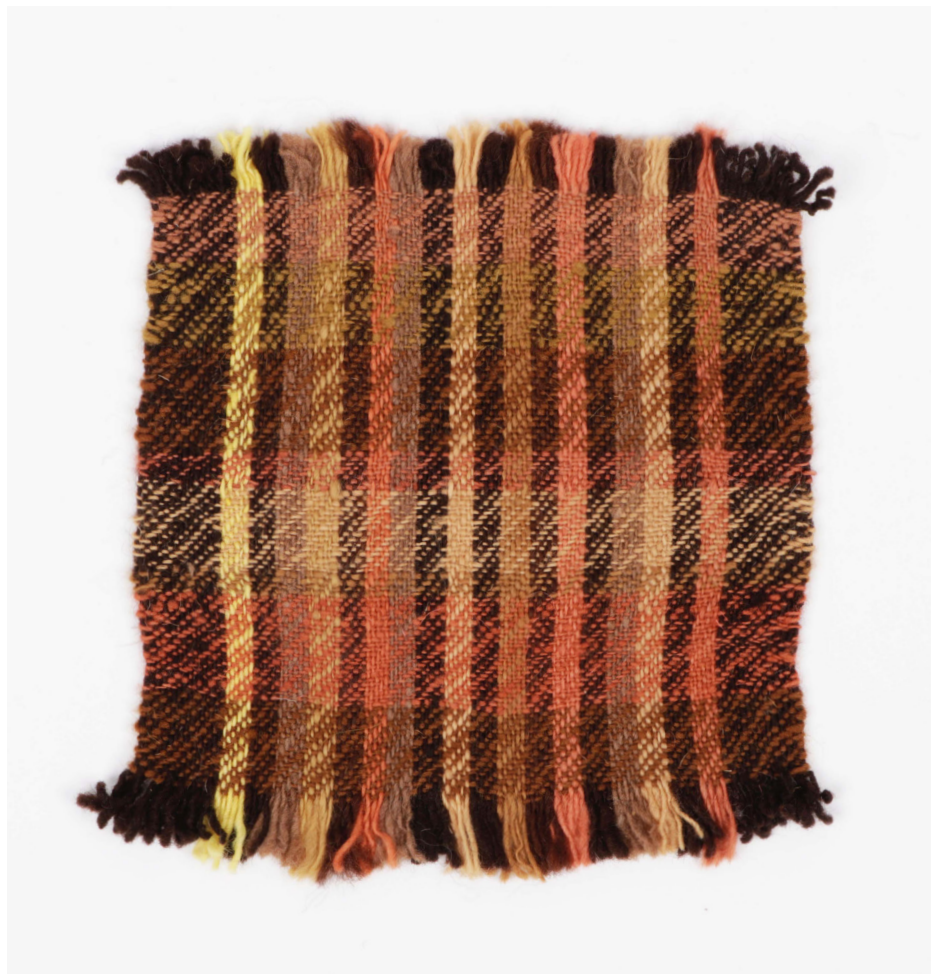
Fig. 298: Amostra V - estrutura neutra composta por tafetá e sarja; trama: Churra Galega Bragançana Branca tingida com castanheiro, Churra Galega Bragançana Branca tingida com ruivinha, Churra Galega Mirandesa tingida com sumagre, Churra Galega Bragançana Branca tingida com oliveira e lírio-dos-tintureiros, Galega Bragançana Branca tingida com ruivinha, Serra da Estrela tingida com rosmaninho e lírio-dos-tintureiros, Churra Galega Bragançana Branca tingida com calêndula e ruivinha; 24cm x 22cm.
