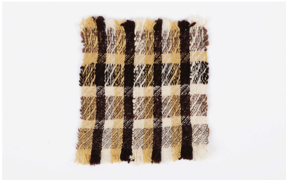
Fig. 252: Amostra V - frente; estrutura composta por tafetá e sarja 3x1; trama: Churra do Minho preta (cinzenta) e Bordaleira de Entre Douro e Minho branca, preta e tingida com figueira; 25cm x 22cm.
