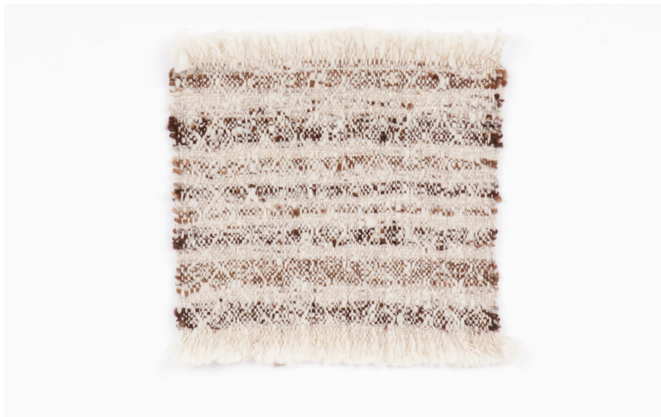
Fig. 230: Amostra II - frente; estrutura composta por tafetá e sarja 2x1; trama: fio mesclado; 23cm x 22cm. Fonte: fotografia da autora (2025).
