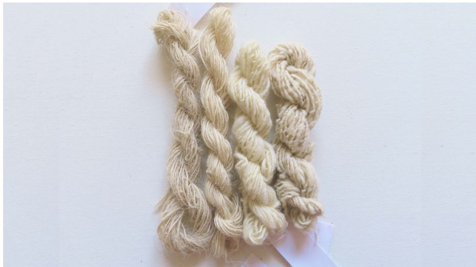
Fig. 188: Meadas com o mesmo diâmetro enroladas. As meadas de Churra Mondegueira e Churra do Campo, à esquerda, são visivelmente menos elásticas do que as meadas de Campaniça e Merino da Beira Baixa (à direita) que, quando enroladas, encolhem. Fonte: fotografia da autora (2025).
