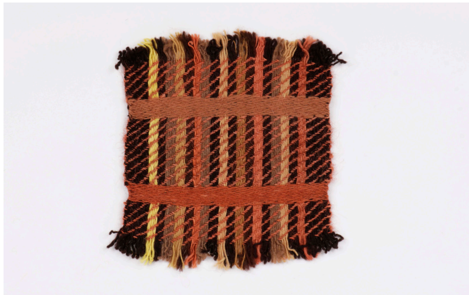
Fig. 293: Amostra II - frente; sarja 6x2 e cetim fingido; trama: Churra da Terra Quente tingida com ruivinha, Churra Galega Bragançana Branca tingida com ruivinha e Churra Galega Bragançana Branca tingida com calêndula e ruivinha; 25cm x 22cm. Fonte: fotografia da autora (2025).
