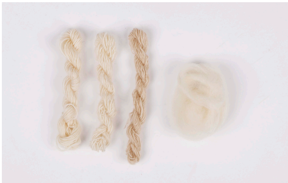
Fig. 115: Fios e lã penteada de Churra Galega Mirandesa branca, da esquerda para a direita: branco brilhante - fio penteado, fibras longas; fio cardado, fibras médias; branco amarelado - fio penteado, fibras longas. Fonte: fotografia da autora (2025).
