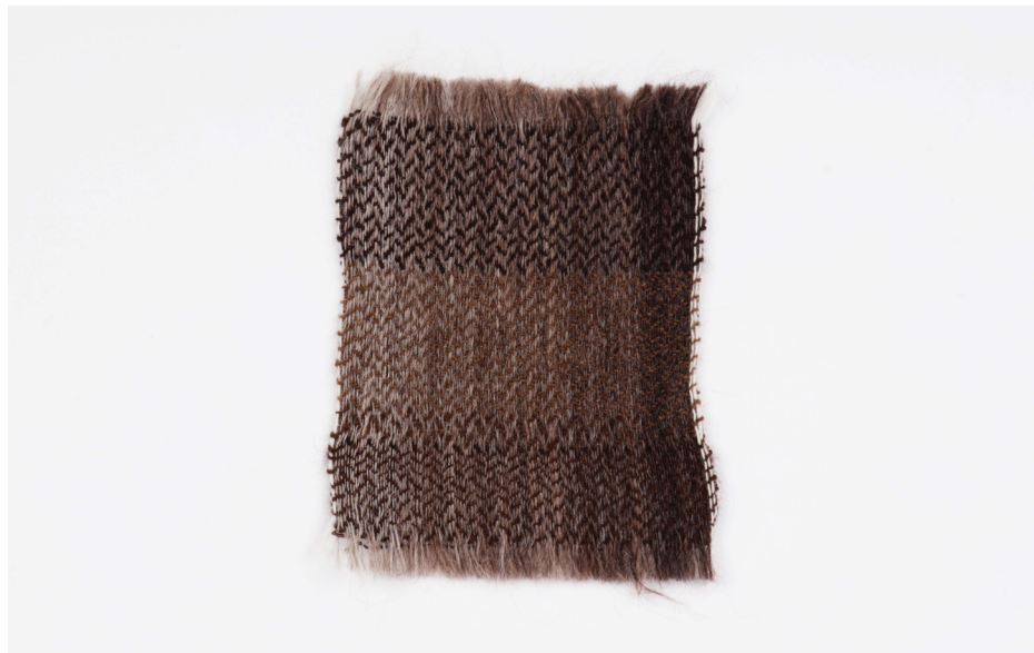
Fig. 215: Amostra II - frente; sarja acetinada; tramas: Campaniça, Merino Preto, Churra Galega Mirandesa; 27cm x 20cm. Fonte: fotografia da autora (2025).
