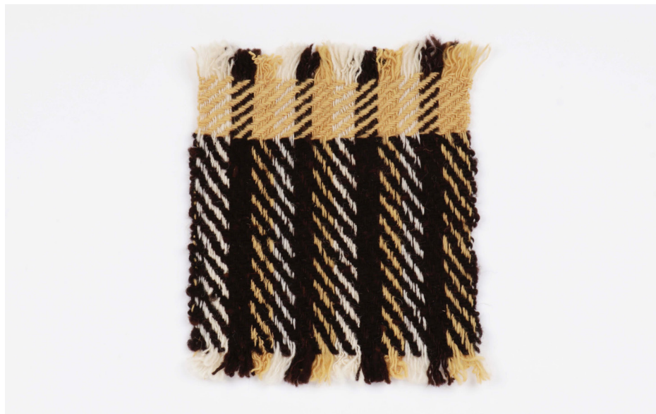
Fig. 247: Amostra III - frente; estrutura neutra composta por sarja 1x3 e sarja 2x2; trama: Bordaleira de Entre Douro e Minho branca e tingida com figueira; 25cm x 22cm. Fonte: fotografia da autora (2025).
