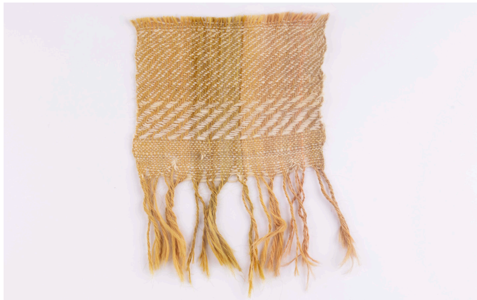
Fig. 78: Amostra I - frente, tafetá, sarja 4x4 e sarja 4x1x2x1, trama: Churra da Terra Quente, 33cm x 24cm.
