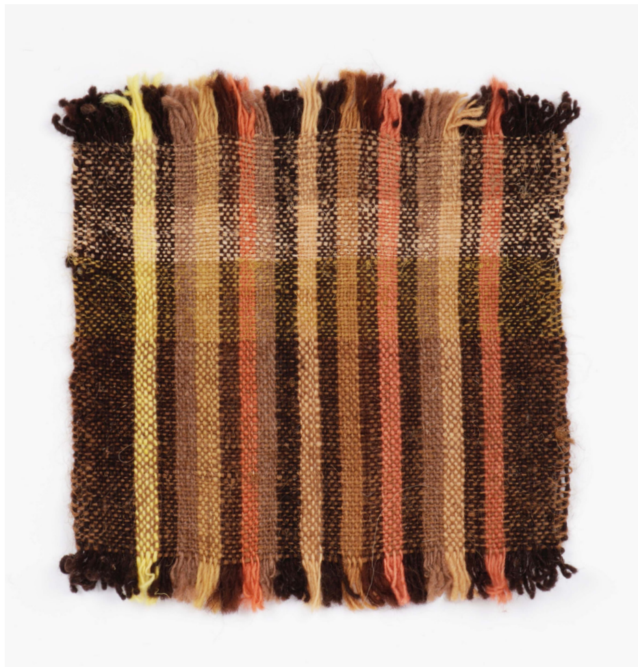
Fig. 297: Amostra IV - tafetá, estrutura neutra; trama: Churra Mondegueira tingida com verbasco e noqueira, Churra da Terra Quente tingida com verbasco e noqueira, Churra da Terra Quente tingida com rosmaninho e lírio-dos-tintureiros, Churra da Terra Quente tingida com oliveira e ruivinha, Churra Mondegueira tingida com íris; 25cm x 24cm. Fonte: fotografia da autora (2025).
