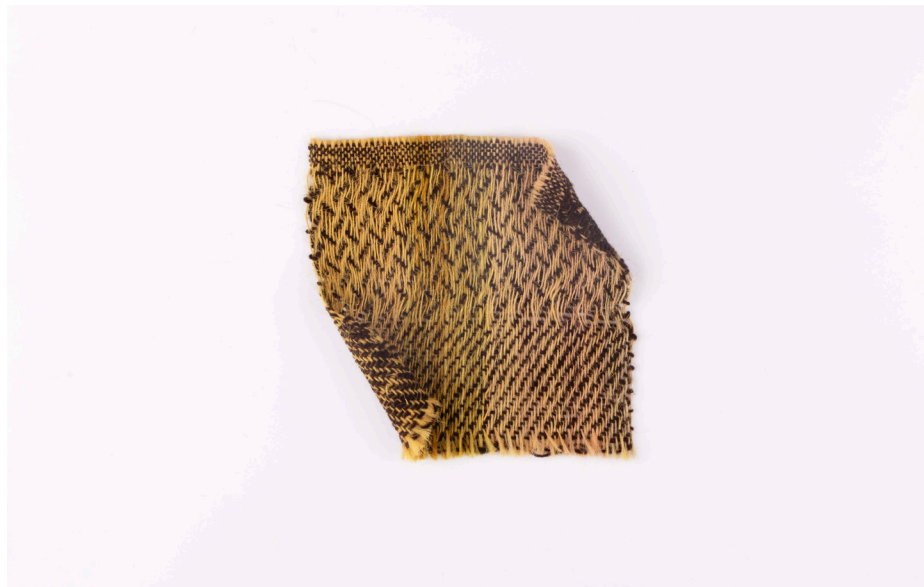
Fig. 82: Amostra III - frente, tafetá, sarja 3x1 e sarja acetinada, trama: Campaniça (preta), 22cm x 21cm.
