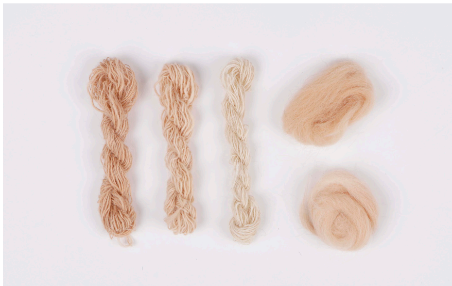
Fig. 105: Fios e lã penteada de Churra Algarvia, da esquerda para a direita: amostra de fio do 1º velo - penteado, fibras longas; penteado, fibras médias; amostra de fio do 2º velo - cardado.
