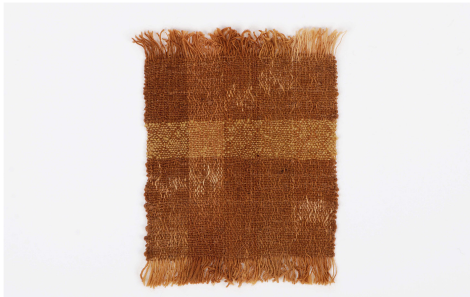
Fig. 271: Amostra IV - frente; estrutura composta por sarja 2x1 e tafetá; trama: Merino da Beira Baixa com anafáia tingida com eucalipto e ferro, e Merino da Beira Baixa tingida com oliveira; 27cm x 21cm.
