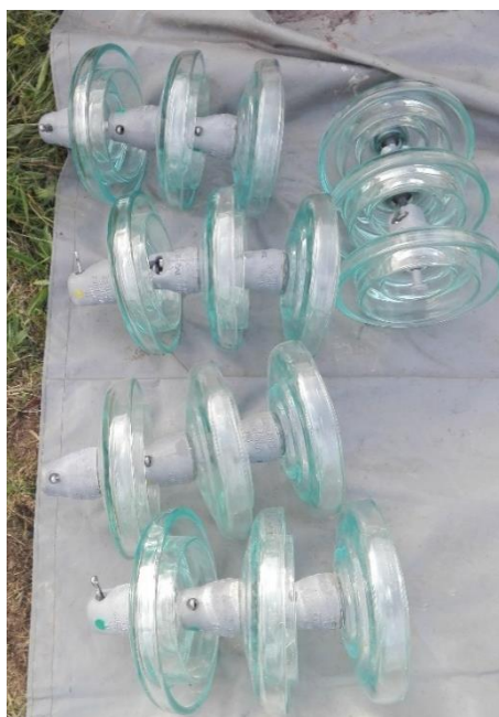
Figura 11 - Isoladores a Colocar.
