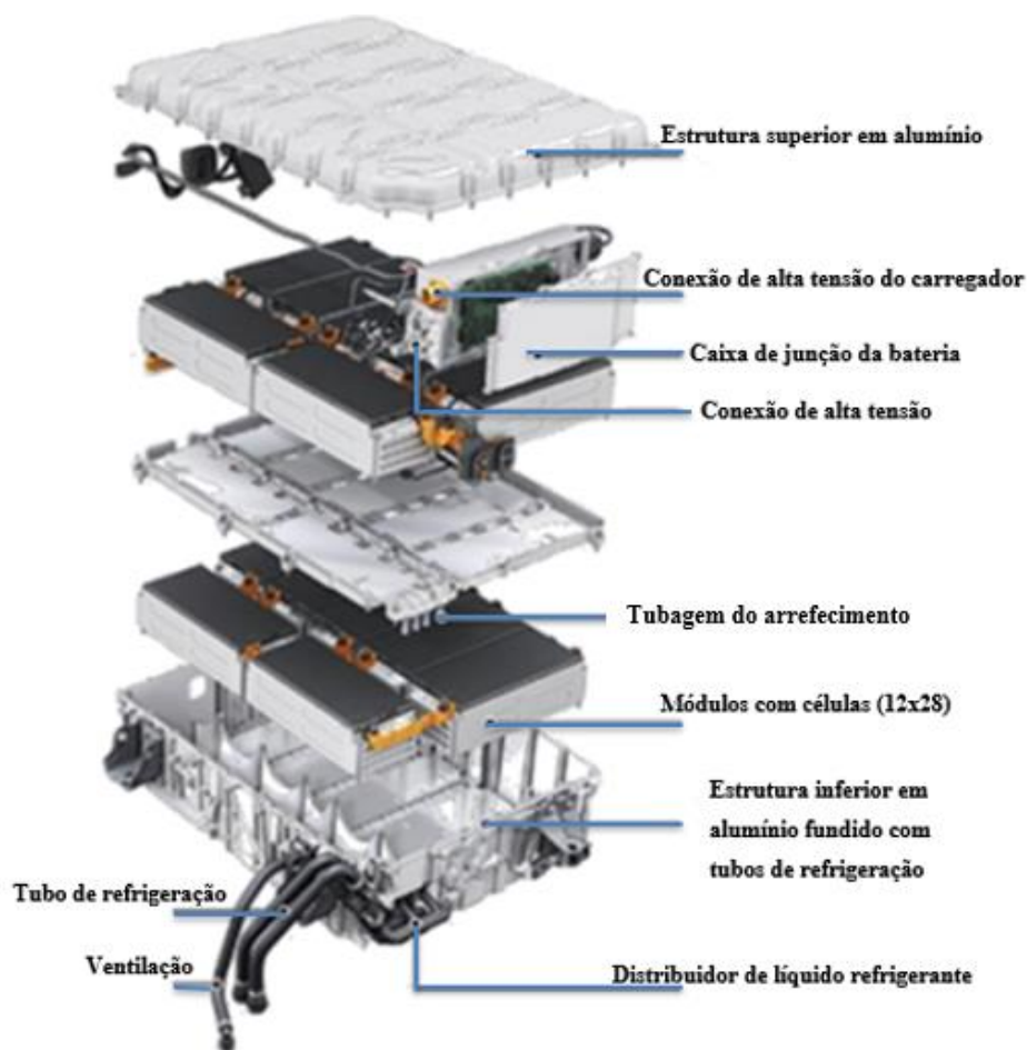
Figura 2.5: Composição de uma bateria de íons lítio aberta, adaptado de Pinto (2018).
