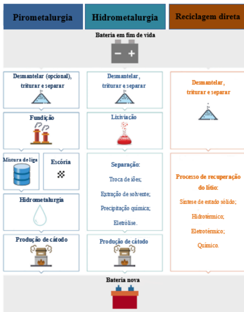
Figura 2.13: Esquema dos métodos de reciclagem por hidrometalurgia, pirometalurgia e reciclagem direta, adaptado de Chen et al. (2019).
