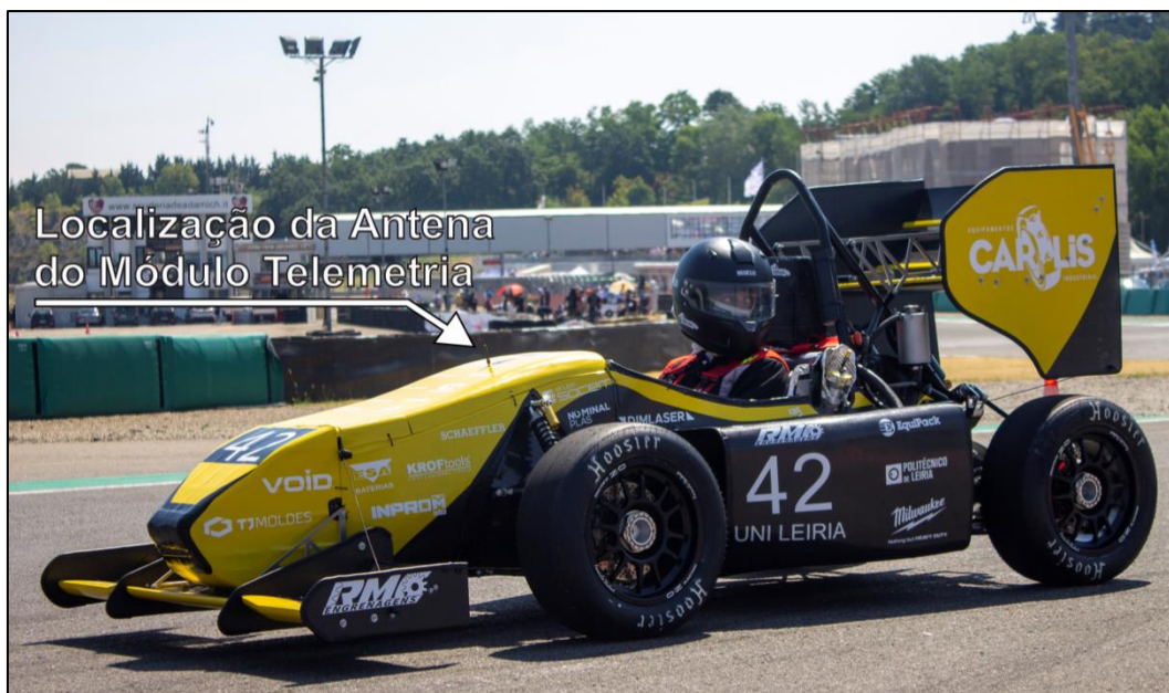
Figura 39 - Localização da Antena da Telemetria no Veículo.
