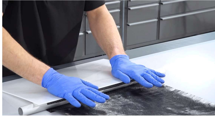
Figura 2.17 – Diagrama do processo de fabrico de tubos por roll wrapping , adaptado de [17]
