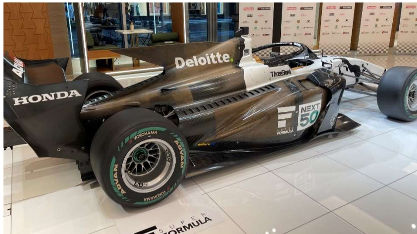
Figura 2.3 – Aplicação de compósitos de fibra natural em painéis num veículo de competição Super Formula (painéis acastanhados) [6]
