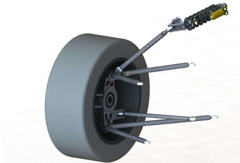
Figura 2.13 – Suspensão frontal direita do veículo de Formula Student T-24e da equipa LART (Leiria Academic Racing Team)
