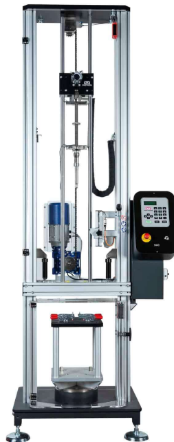
Figura 5.3 – Máquina para testes de queda de peso [51]
