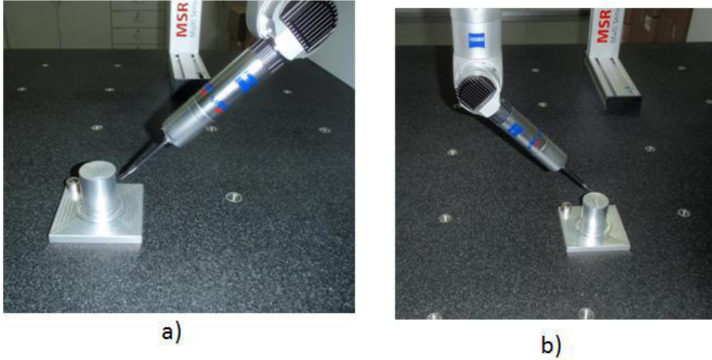
Figura 3.23 Ângulos de medição utilizados para o stylus -Z11mmR0.50mm; a)A00 B-45; b)A00 B45
