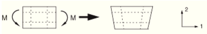
Figura 10: Elemento finito linear de integração completa sob flexão pura.
