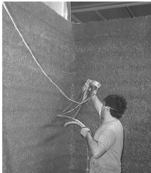
Figura 13: Produção de elemento com método spray-up [26]
