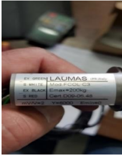
Figura 15: Célula de carga FCOL-C3-200kg[27]
