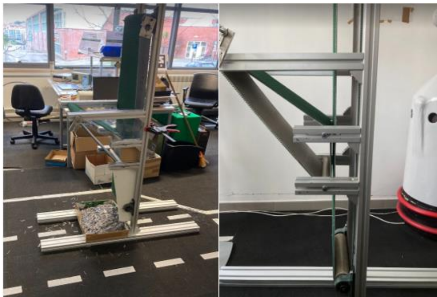
Figura 51: Mecanismo de separação com telas abrasivas
