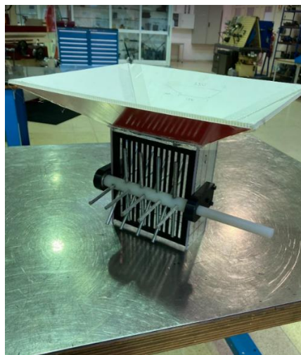
Figura 50: Protótipo da garganta com eixo separador
