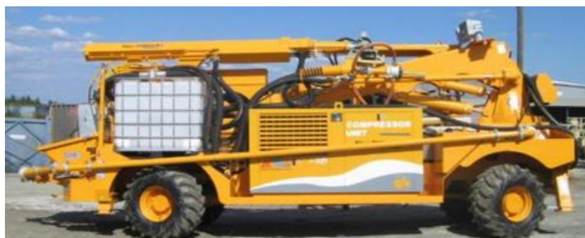
Figura 24: Equipamento de projecção PM 500 PC[30]
