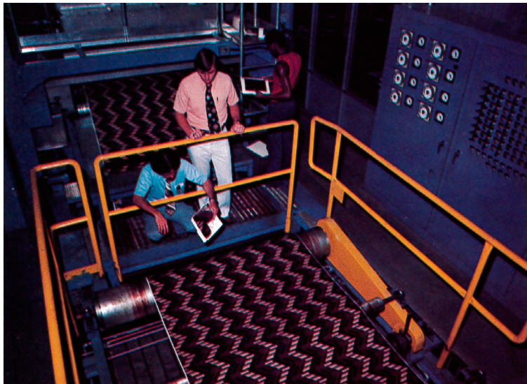
Figura 4. Millitron - primeira impressora digital têxtil (Milliken, 1973).
