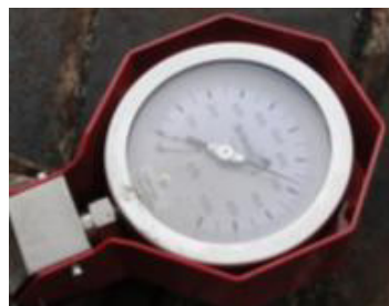
Figura 53: Execução de Ensaios de resistência das ancoragens
