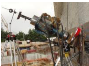
Figura 53: Execução de Ensaios de resistência das ancoragens
