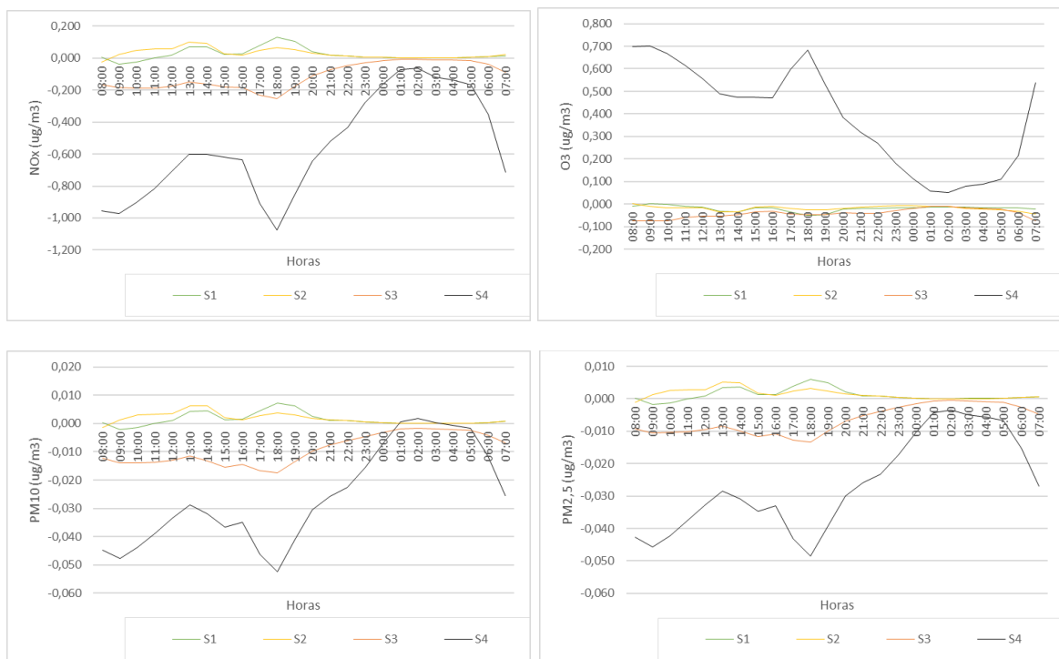
Figura 28 - Diferenças nas concentrações de NOx, O 3 , PM10 e PM2,5 ao longo do dia (z=1,5m).
