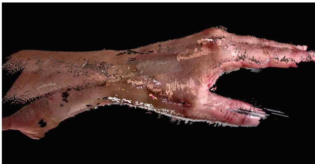
Fig.23 Resultado de digitalização com movimento
