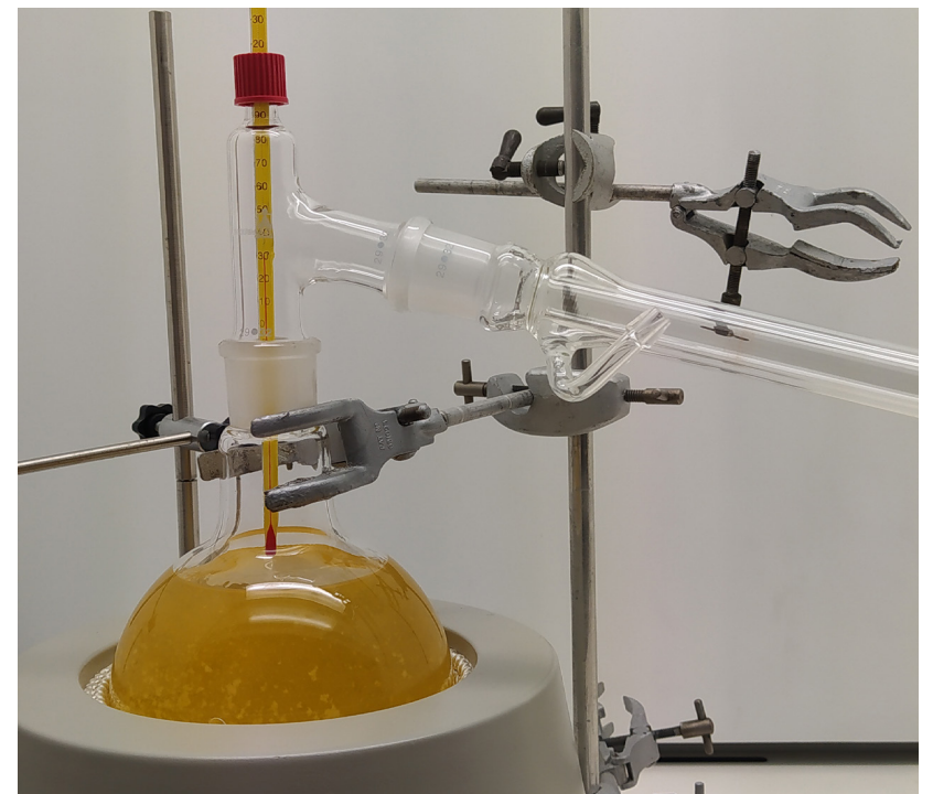
Figura 156| Processo de destilação do álcool, usando um kit de destilação para obtenção do pigmento isolado e recuperação do solvente. Fotografia da autora
