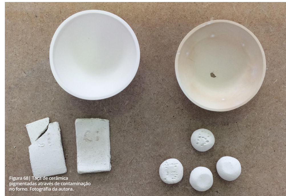
Figura 70| Taça de cerâmica pigmentadas através de contaminação no forno. Fotografia da autora.
