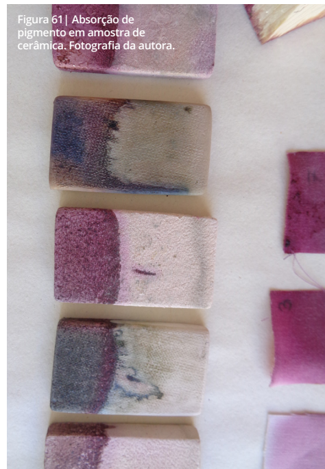
Figura 62 | Absorção de pigmento em amostra de cerâmica e tecido. Fotografia da autora.
