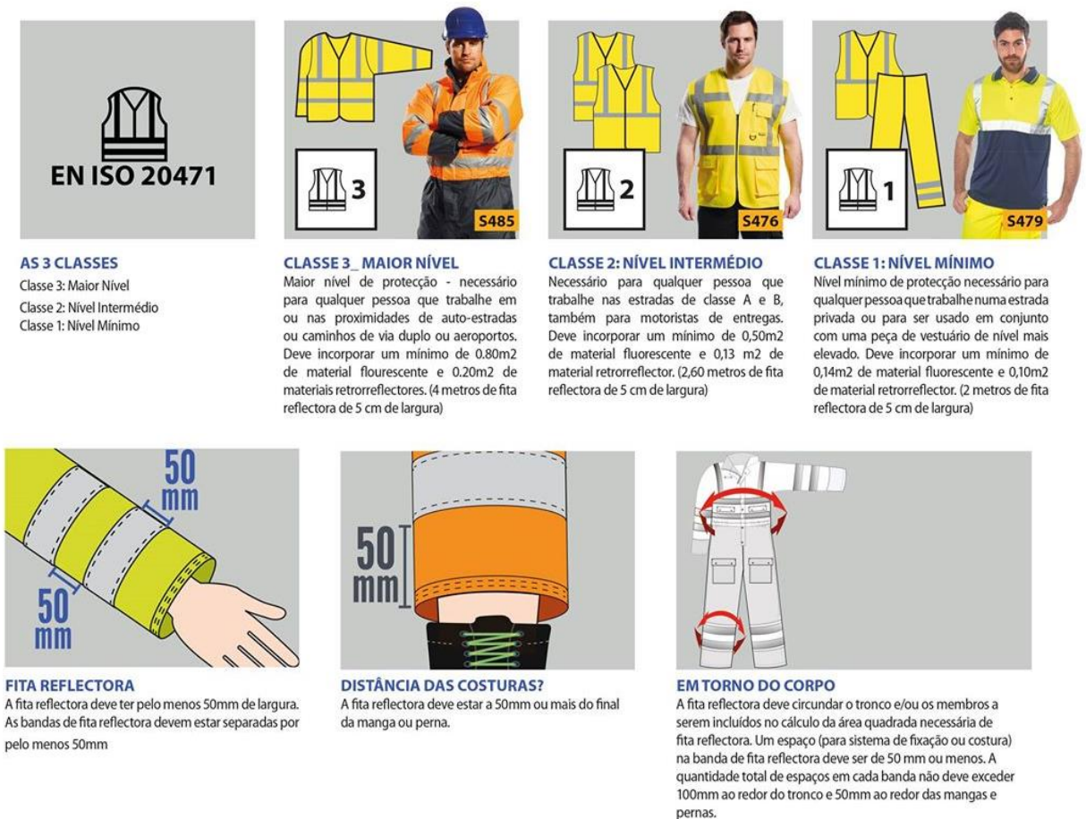
Figura 60 – Requisitos de fita refletora em roupa de alta visibilidade
