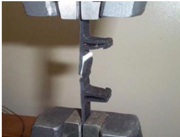
Figura 48 - Fotos dos ensaios destrutivos para testar a qualidade das soldaduras (5)
