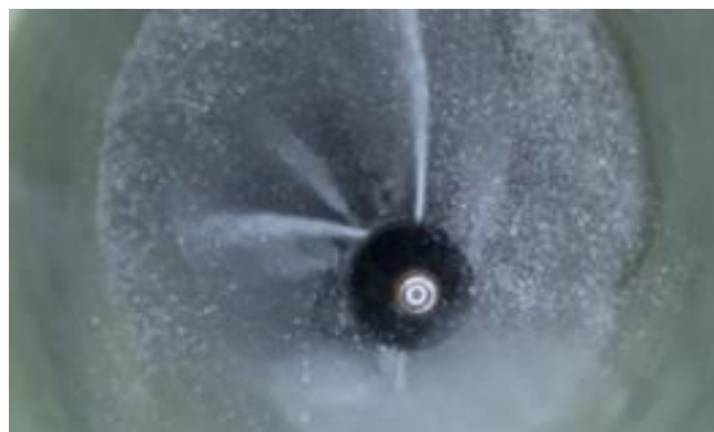
Figura 33 – Ensaio ao Stress através de jatos de água de alta pressão (5)
