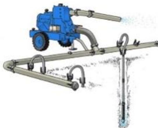
Figura 18 - Equipamento para rebaixamento do nível freático (8)
