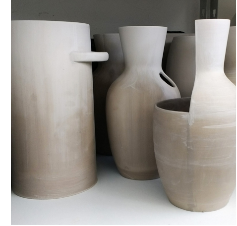
Imagem 47 Degradê de secagem das peças. Desenvolvimento do projeto, processo cerâmico de construção das peças. Fotografia da autora.
