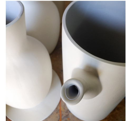
Imagem 48, Imagem 49 Peças chacotadas com o interior vidrado. Desenvolvimento do projeto, processo cerâmico de vidragem das peças. Consoante as formas, as jarras eram vidradas por mergulho ou o interior era primeiro vidrado por enchimento e o exterior vidrado à pistola. Este último processo foi o mais usado. Fotografias da autora.
