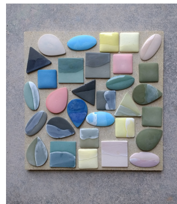
Imagem 134 Amostras de cor. Estudos de cor, de vidrados e de pastas coradas. Desenvolvimento do projeto, processo cerâmico de vidragem das peças. Fotografia da autora.
