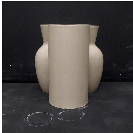
Imagem 23 Detalhes: formas. Desenvolvimento do projeto, experiência de modelação dos contentores em barro fresco com diferentes elementos do espaço arquitetónico: cantos, quinas, rodapés, etc. A experiência revelou não funcionar como esperado, devido a construção cerâmica das peças ser de enchimento por via líquida e não de modelação manual. O que faz com que as peças não tenham flexibilidade suficiente e rachem ou partam, quando encaixadas ou adaptadas a estes elementos. Apesar dos resultados não serem viáveis e terem sido destruídos durante o processo, esta experiência ajudou na visualização individual e em grupo num espaço e com isto no desenho formal das peças. Fotografia da autora.
