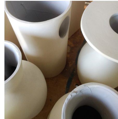
Imagem 48, Imagem 49 Peças chacotadas com o interior vidrado. Desenvolvimento do projeto, processo cerâmico de vidragem das peças. Consoante as formas, as jarras eram vidradas por mergulho ou o interior era primeiro vidrado por enchimento e o exterior vidrado à pistola. Este último processo foi o mais usado. Fotografias da autora.
