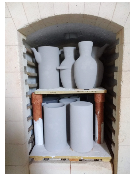
Imagem 51, Imagem 52 Fornada, o antes e depois. Desenvolvimento do projeto, processo de cozedura de faiança a baixa temperatura. No total, foram feitas cinco fornadas, com cerca de vinte peças cada. Fotografias da autora.
