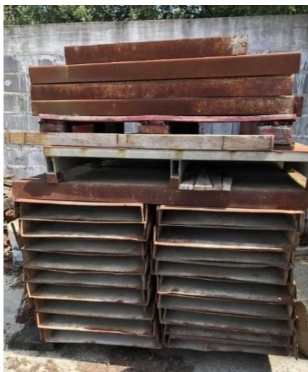
Figura 24: Tabuleiros com oxidação exposta.
