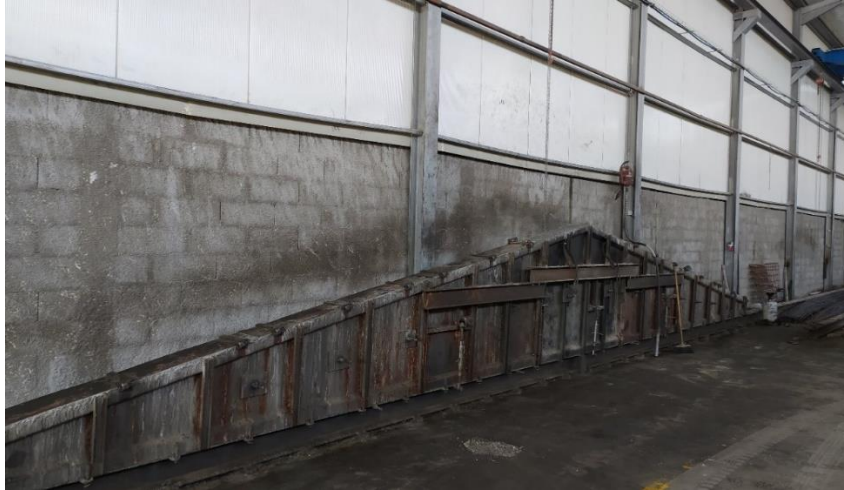
Figura 26: Molde da asna montado.
