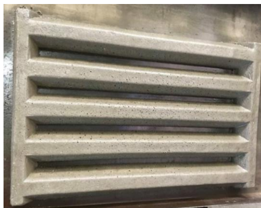
Figura 6: Selete em processo de cura utilizada no piso do salão de engorda.
