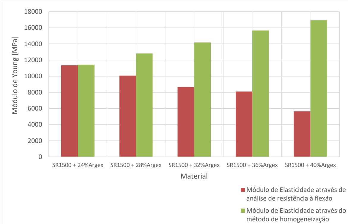
Figura 26 – Gráfico de comparação de resultados obtidos através da análise de resistência à flexão e pelo método de homogeneização.
