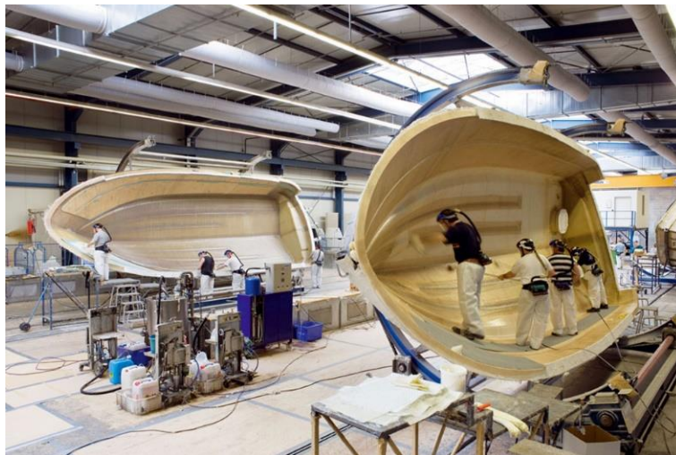
Figura 5 - Fabricação de um casco de barco em fibra de vidro e epóxida (Imagem retirada de [9]).
