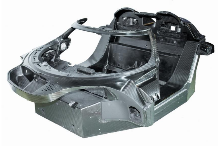
Figura 2 - Exemplo de monocoque em fibra de carbono (Imagem retirada de [6]).
