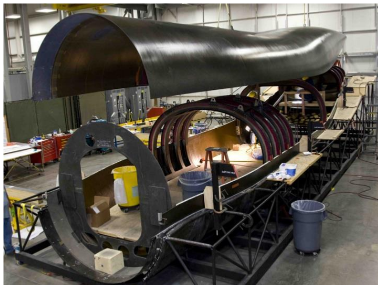
Figura 3 - Fabricação de uma fuselagem de um avião com fibra de carbono e epóxida (Imagem retirada de [7]).
