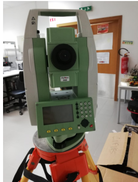
Figura 13: Teodolito utilizado para as obter as coordenadas (x, y, z) dos pontos de referência em testes.
