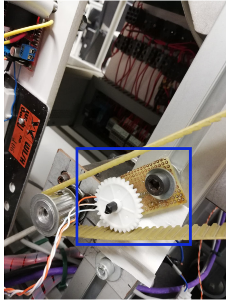
Figura 62: Encoder (retângulo azul) utilizado para contar os pulsos do tapete. A fixação foi feita no perfil de alumínio, através de uma pequena placa de circuito impresso, e a sua conexão a um Arduino Uno para detecção dos pulsos. Adicionalmente, para obter os pulsos através do movimento da correia, foi colocada uma roda dentada no eixo do encoder.
