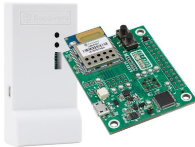
Figura 9: Dispositivo DWM1001 pertencente ao kit de desenvolvimento MDEK1001 - Decawave
