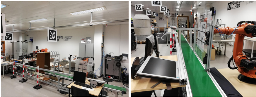
Figura 31: Cenário e tapete transportador linear no qual o teste dinâmico foi efetuado. As comunicações UWB para este cenário sofreram de diversos impactos devido aos vários obstáculos existentes.
